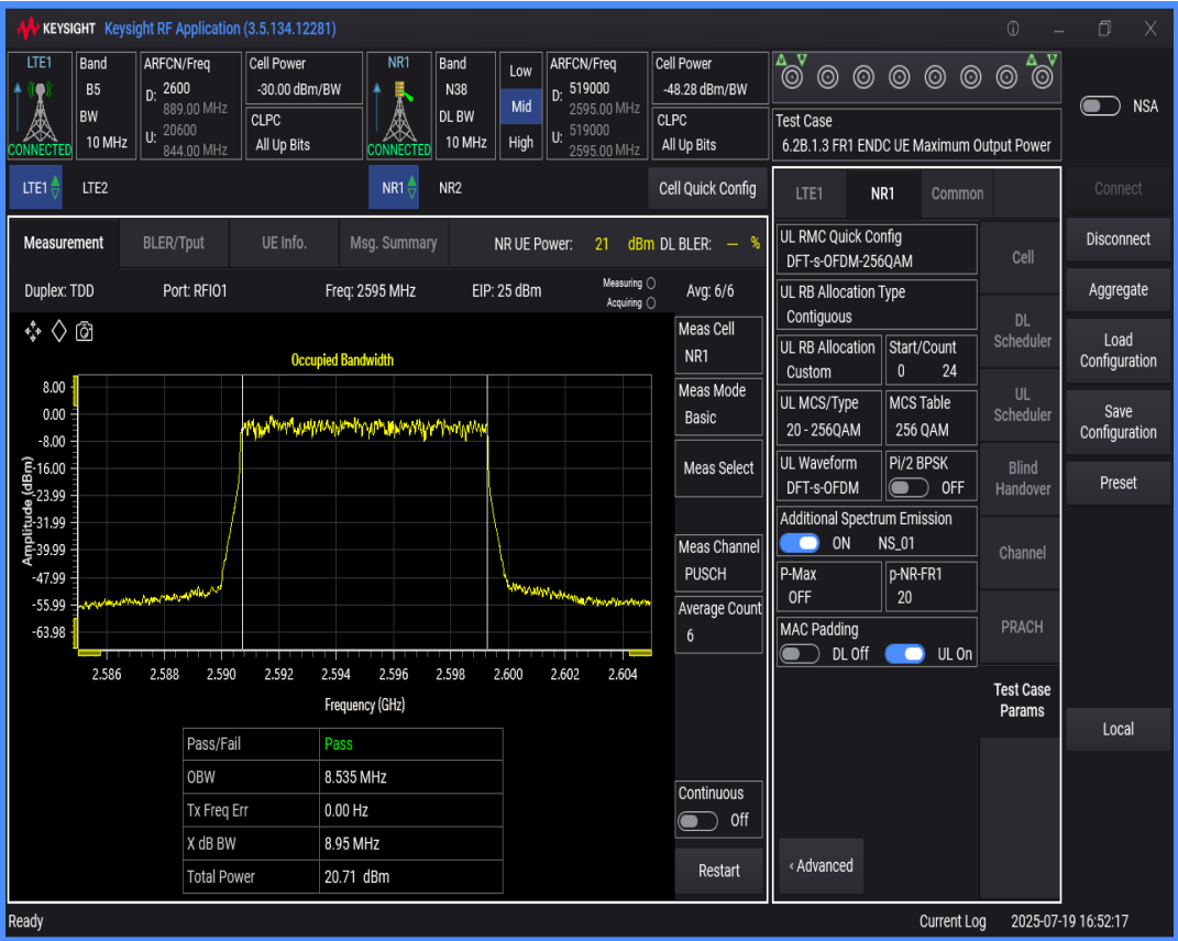
n38 SCS=30kHz DFT_QAM16 BW=20MHz Channel=519000 RB=50@0
