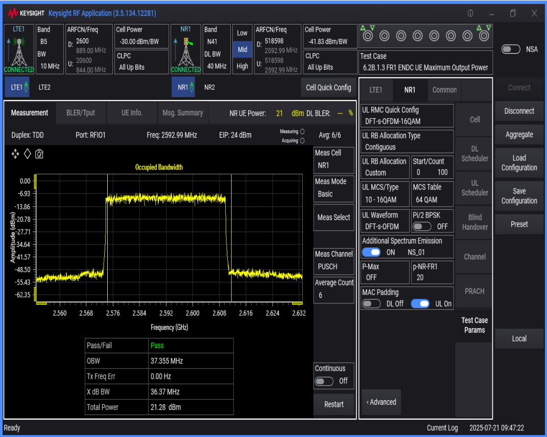
n41 SCS=30kHz DFT_QAM16 BW=20MHz Channel=518598 RB=50@0
