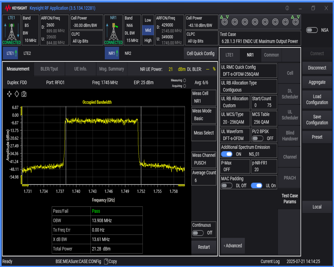
n66 SCS=15kHz DFT_QAM256 BW=20MHz Channel=349000 RB=100@0
