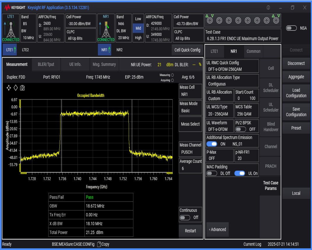
n66 SCS=15kHz DFT_QPSK BW=10MHz Channel=349000 RB=50@0
