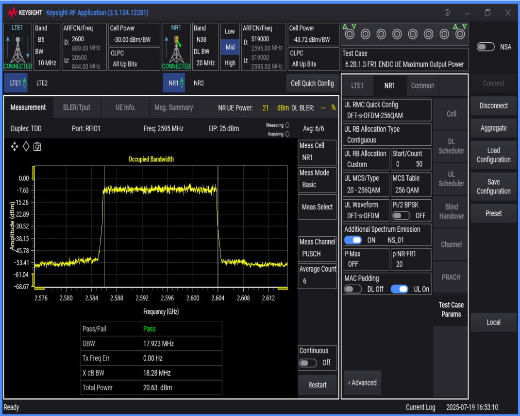
n38 SCS=30kHz DFT_QAM64 BW=20MHz Channel=519000 RB=50@0
