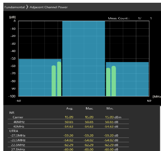
40MHz_30kHz_3680MHz-OFDM QPSK_RB100@0 -53.78,-54.02dB
