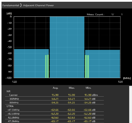
80MHz_30kHz_3590MHz-OFDM QPSK_RB216@0 -51.55,-52.42dB
