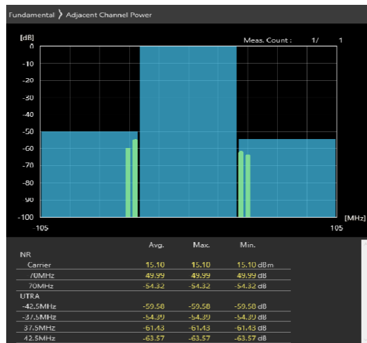
70MHz_30kHz_3665MHz-OFDM QPSK_RB180@0 -52.92,-52.9dB
