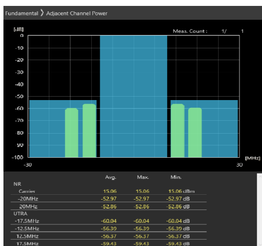
20MHz_30kHz_3690MHz-OFDM QPSK_RB25@12 -54.04,-54.34dB
