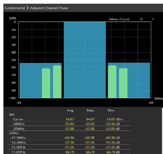
20MHz_30kHz_3690MHz-OFDM QPSK_RB50@0 -53.88,-53.79dB
