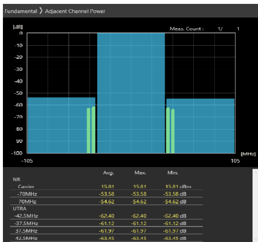
70MHz_30kHz_3665MHz-OFDM QPSK_RB1@188 -53.74,-50.14dB
