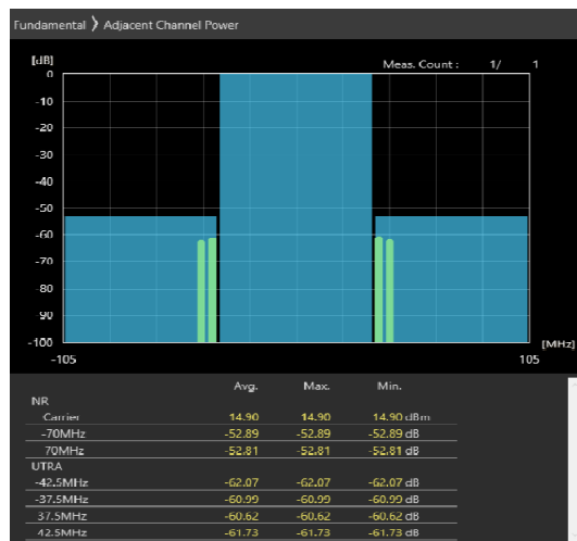
70MHz_30kHz_3665MHz-OFDM QPSK_RB90@45 -53.44,-54.66dB
