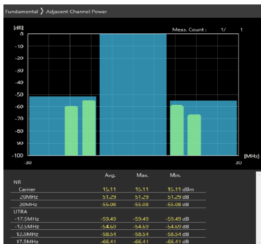
20MHz_30kHz_3560MHz-OFDM QPSK_RB50@0 -52.97,-52.86dB
