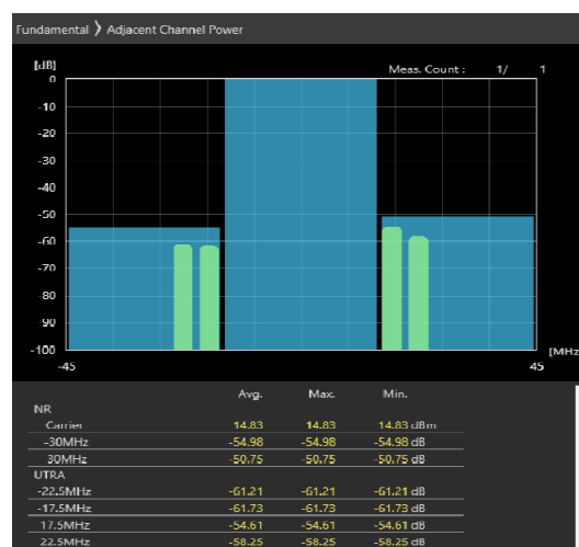
30MHz_30kHz_3685MHz-OFDM QPSK_RB75@0 -53.97,-53.88dB
