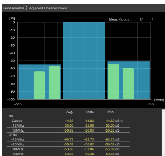
15MHz_30kHz_3692.5MHz-OFDM QPSK_RB1@37 -55,-50.83dB
