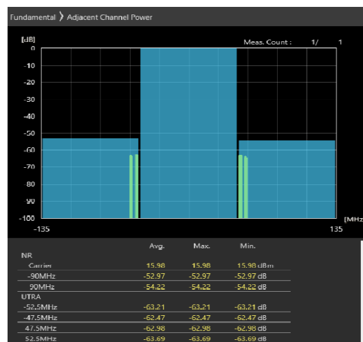
90MHz_30kHz_3655MHz-OFDM QPSK_RB243@0 -52.63,-52.01dB
