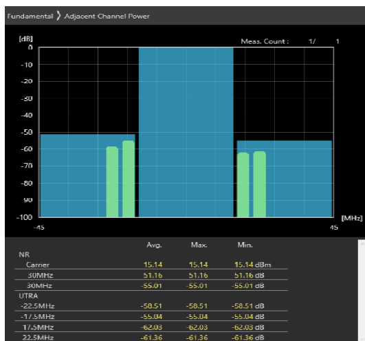
30MHz_30kHz_3565MHz-OFDM QPSK_RB75@0 -52.96,-53.2dB
