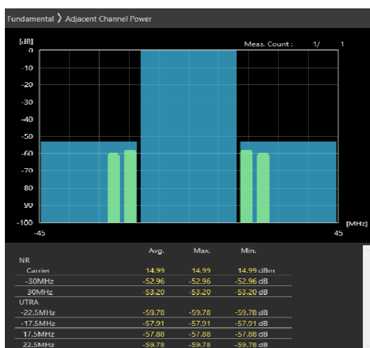
30MHz_30kHz_3685MHz-OFDM QPSK_RB36@18 -54.47,-55.23dB
