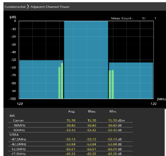
80MHz_30kHz_3660MHz-OFDM QPSK_RB108@54 -53.27,-54.30dB
