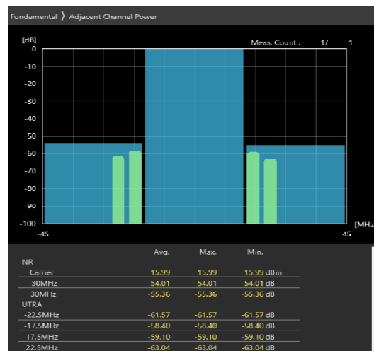
30MHz_30kHz_3685MHz-OFDM QPSK_RB1@77 -54.98,-50.75dB
