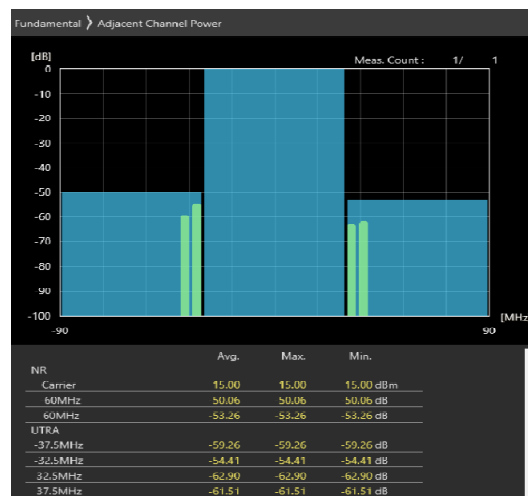
60MHz_30kHz_3670MHz-OFDM QPSK_RB162@0 -52.81,-52.72dB
