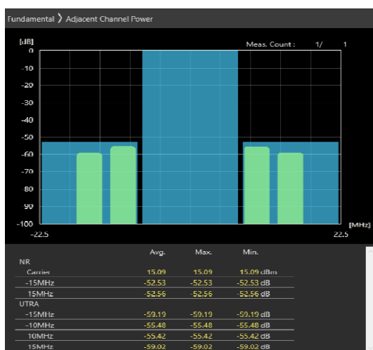
15MHz_30kHz_3692.5MHz-OFDM QPSK_RB1@37 -55,-50.83dB
