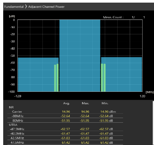
80MHz_30kHz_3660MHz-OFDM QPSK_RB216@0 -52.64,-51.95dB
