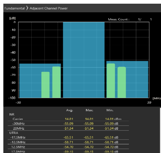
20MHz_30kHz_3690MHz-OFDM QPSK_RB50@0 -53.88,-53.79dB
