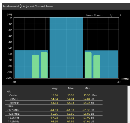
20MHz_30kHz_3690MHz-OFDM QPSK_RB25@12 -54.04,-54.34dB
