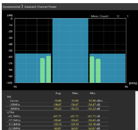
30MHz_30kHz_3685MHz-OFDM QPSK_RB36@18 -54.47,-55.23dB
