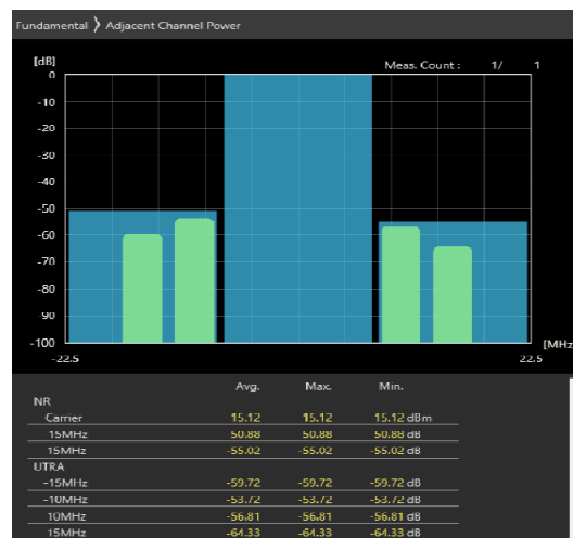
15MHz_30kHz_3692.5MHz-OFDM QPSK_RB18@9 -53.56,-53.81dB
