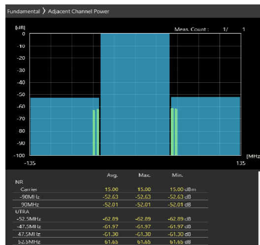
90MHz_30kHz_3655MHz-OFDM QPSK_RB243@0 -52.63,-52.01dB
