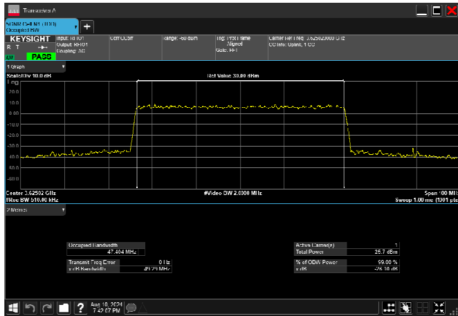
n78_2_60MHz_30kHz_3625MHz_DFT-s-OFDM QPSK_RB162@0 57.704MHz
