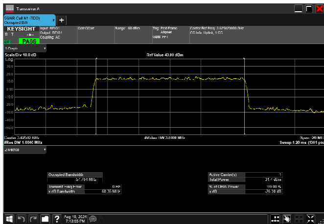
n78_2_60MHz_30kHz_3625MHz_DFT-s-OFDM QPSK_RB162@0 57.704MHz
