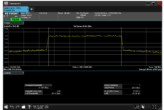
n78_2_60MHz_30kHz_3625MHz_DFT-s-OFDM \pi/2 BPSK_RB162@0 57.683MHz
