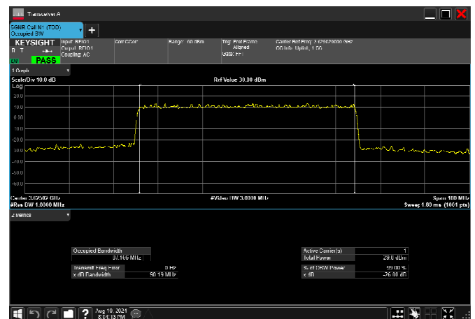
n78_2_90MHz_30kHz_3625MHz_CP-OFDM QPSK_RB245@0 87.166MHz
