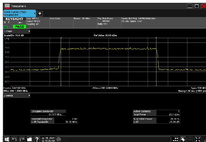
n78_2_100MHz_30kHz_3625MHz_DFT-s-OFDM \pi/2 BPSK_RB270@0 96.509MHz
