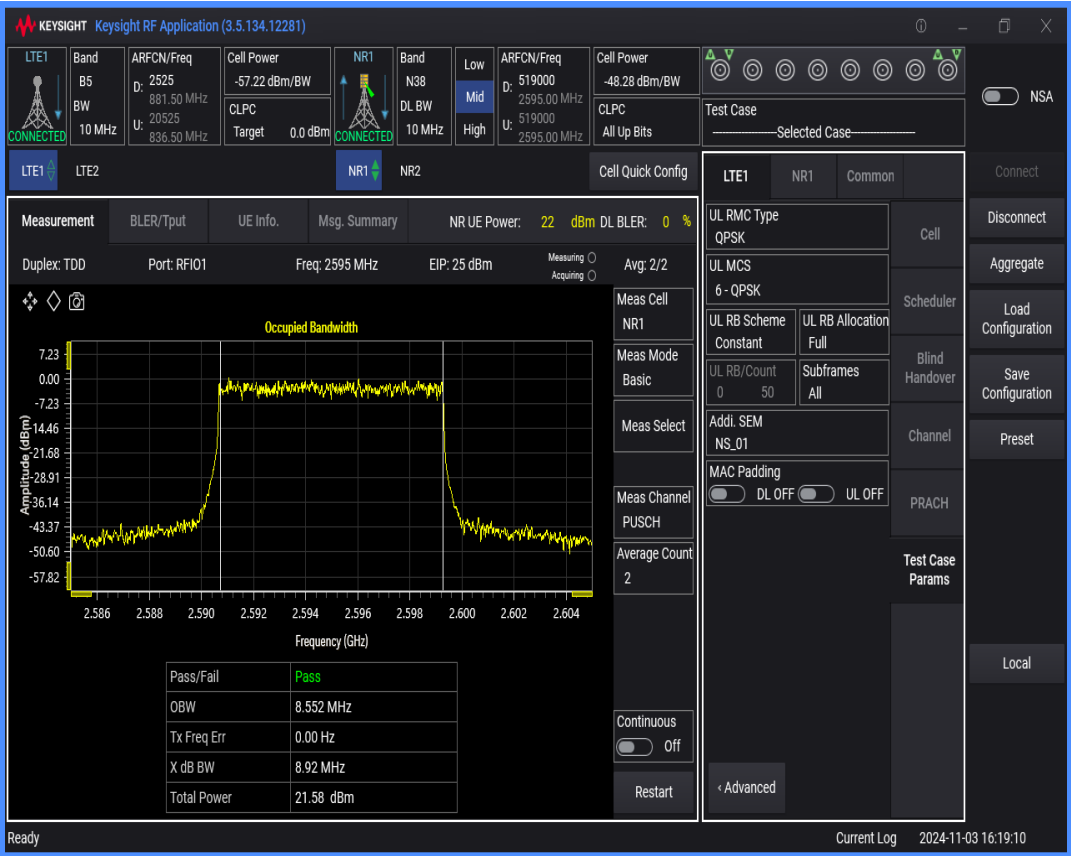
n38 SCS=30kHz DFT_BPSK BW=20MHz Channel=519000 RB=50@0
