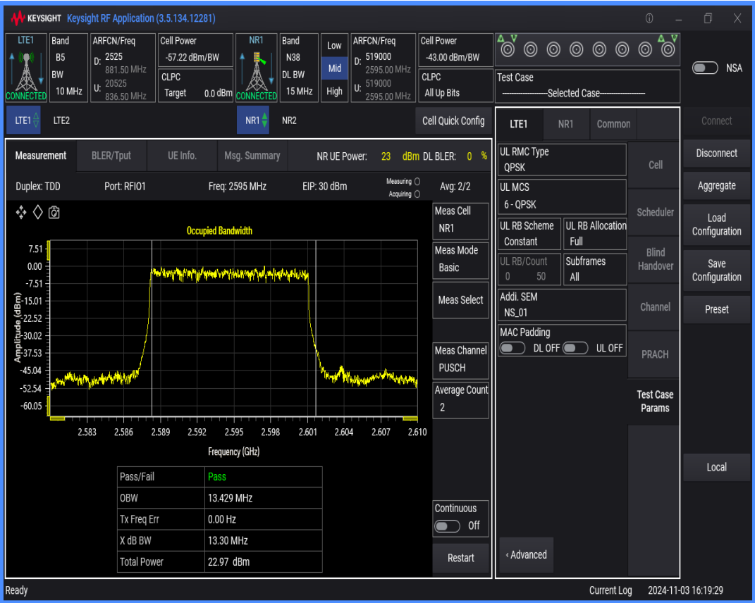
n38 SCS=30kHz DFT_BPSK BW=10MHz Channel=519000 RB=24@0
