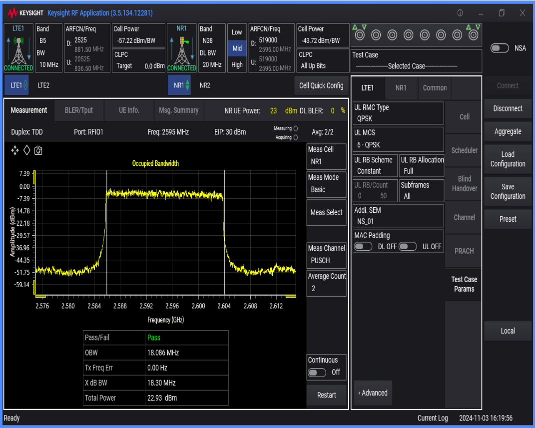
n38 SCS=30kHz DFT_QAM64 BW=20MHz Channel=519000 RB=50@0
