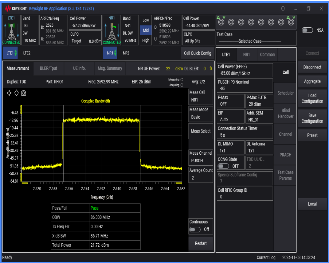
n41 SCS=30kHz DFT_QAM256 BW=20MHz Channel=518598 RB=50@0
