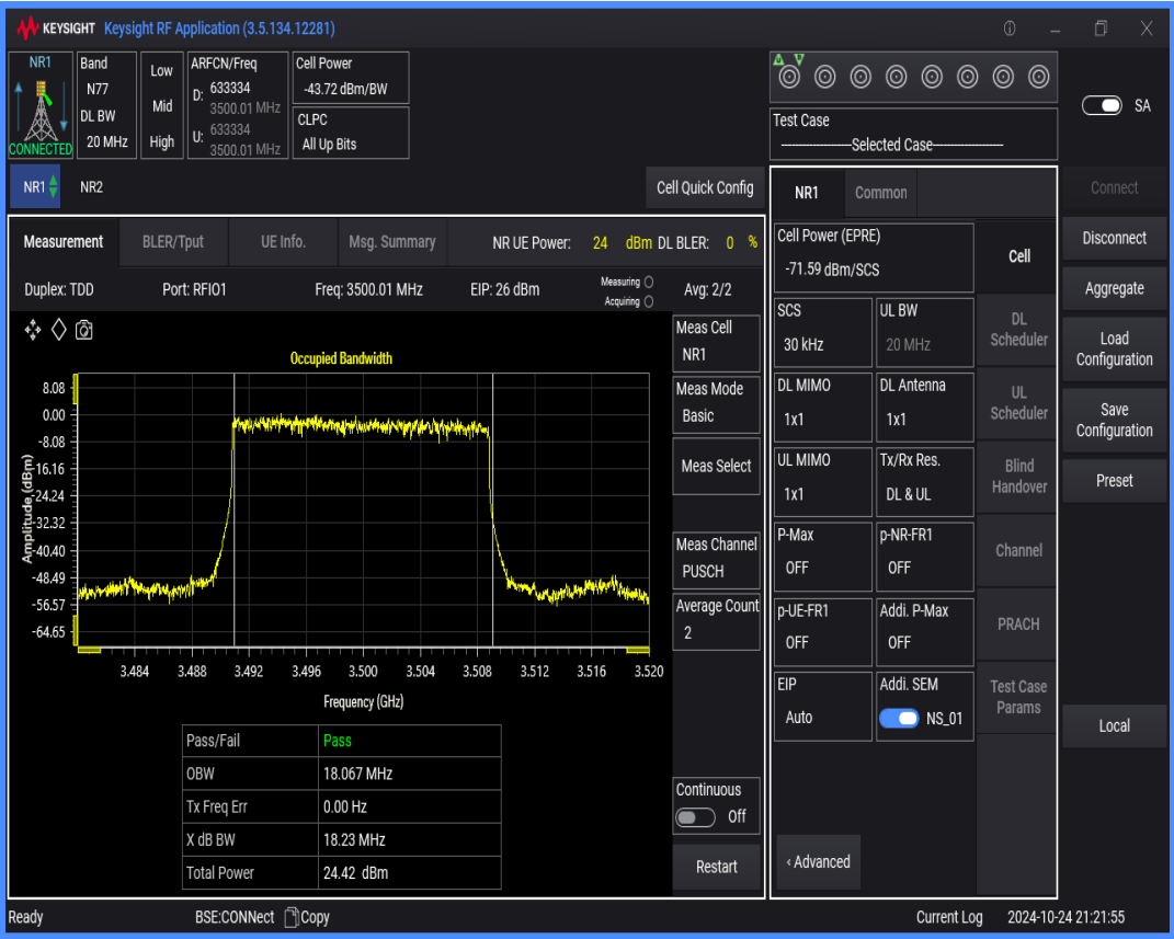
n77(3450-3550) SCS=30kHz DFT_QPSK BW=20MHz Channel=633334 RB=50@0
