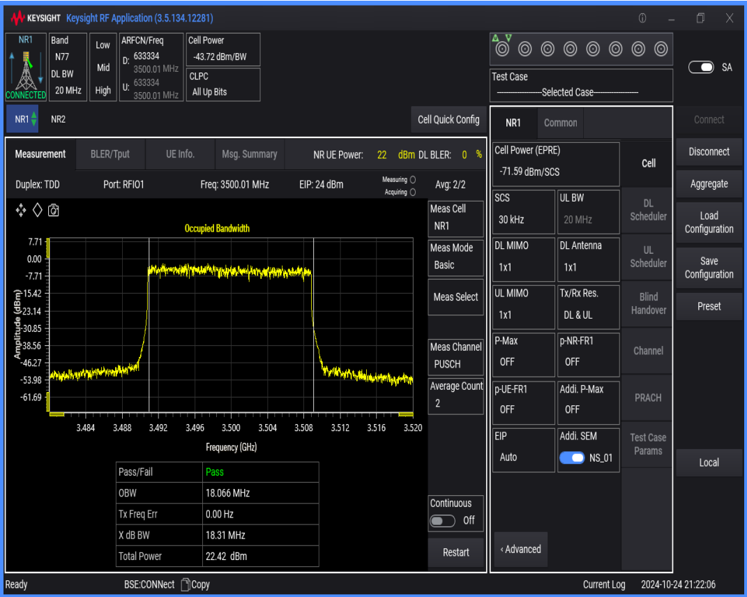
n77(3450-3550) SCS=30kHz DFT_QAM256 BW=20MHz Channel=633334 RB=50@0
