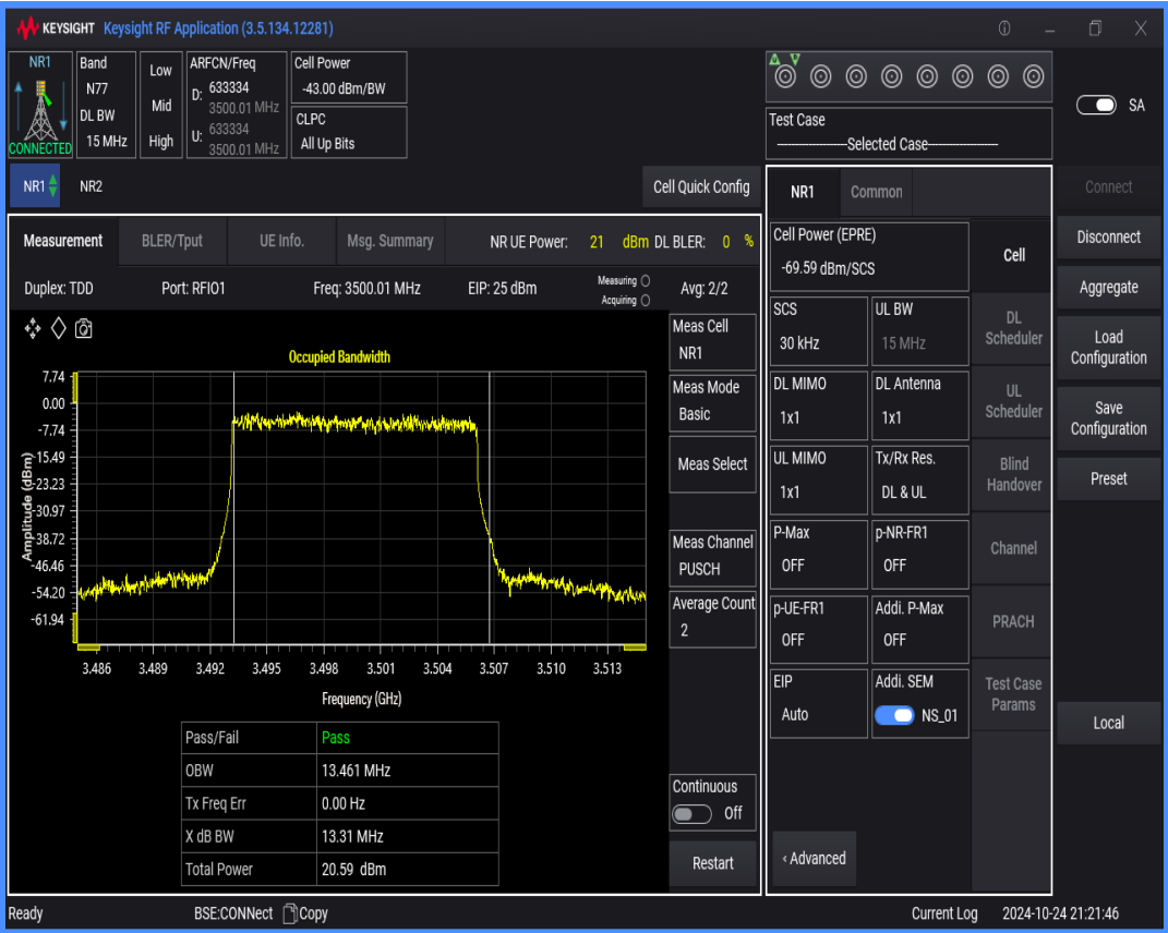
n77(3450-3550) SCS=30kHz DFT_BPSK BW=20MHz Channel=633334 RB=50@0
