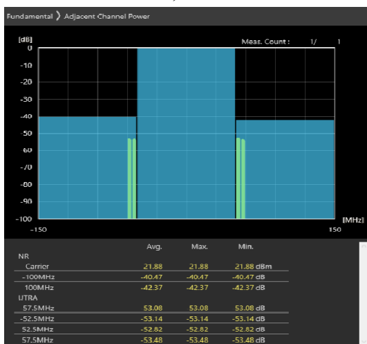
100MHz_30kHz_3650MHz-OFDM QPSK_RB1@272 -45.54,-46.21dB
