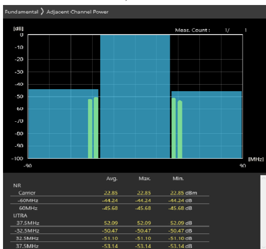
60MHz_30kHz_3670MHz-OFDM QPSK_RB1@161 -47.13,-47.21dB
