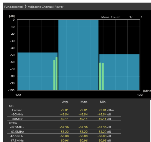
80MHz_30kHz_3660MHz-OFDM QPSK_RB108@54 -43.83,-45dB
