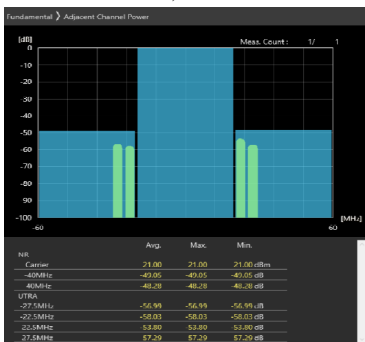
40MHz_30kHz_3680MHz-OFDM QPSK_RB1@105 -49.05,-48.28dB
