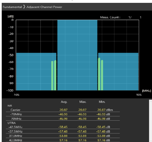
70MHz_30kHz_3665MHz-OFDM QPSK_RB1@188 -46.93,-46.98dB
