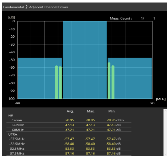
60MHz_30kHz_3670MHz-OFDM QPSK_RB1@161 -47.13,-47.21dB
