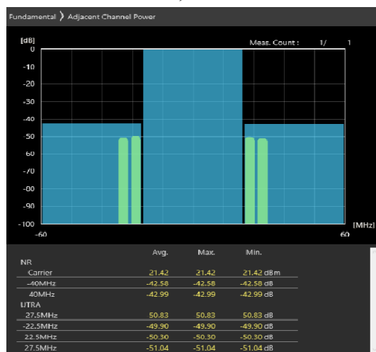
40MHz_30kHz_3680MHz-OFDM QPSK_RB50@25 -45.08,-46.99dB
