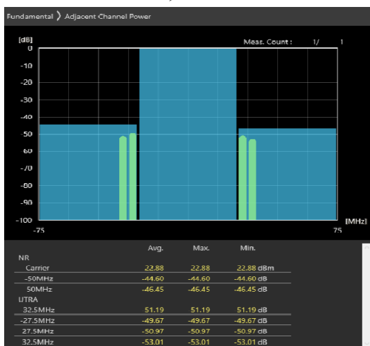
50MHz_30kHz_3675MHz-OFDM QPSK_RB1@132 -48.24,-48.09dB
