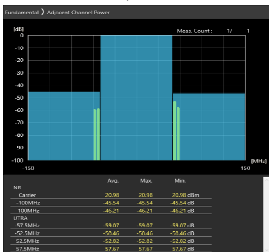
100MHz_30kHz_3650MHz-OFDM QPSK_RB1@272 -45.54,-46.21dB
