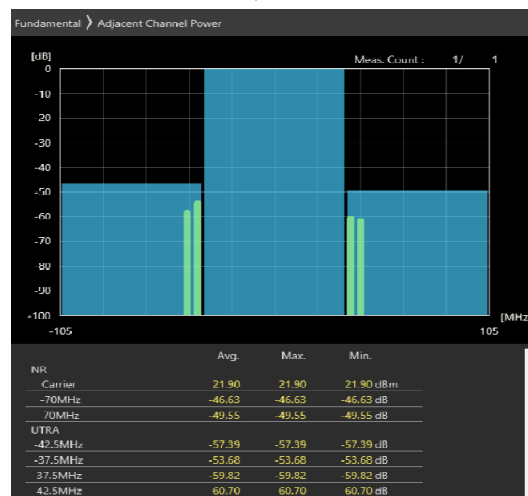
70MHz_30kHz_3665MHz-OFDM QPSK_RB180@0 -41.72,-42.3dB
