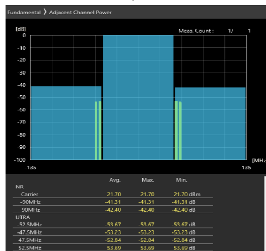
90MHz_30kHz_3655MHz-OFDM QPSK_RB243@0 -41.31,-42.4dB
