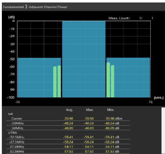
50MHz_30kHz_3675MHz-OFDM QPSK_RB1@132 -48.24,-48.09dB
