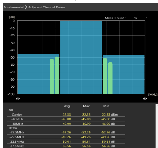
40MHz_30kHz_3680MHz-OFDM QPSK_RB50@25 -45.08,-46.99dB
