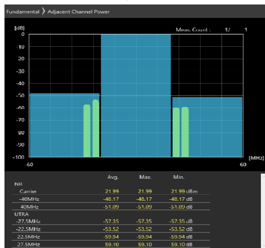
40MHz_30kHz_3680MHz-OFDM QPSK_RB100@0 -42.58,-42.99dB
