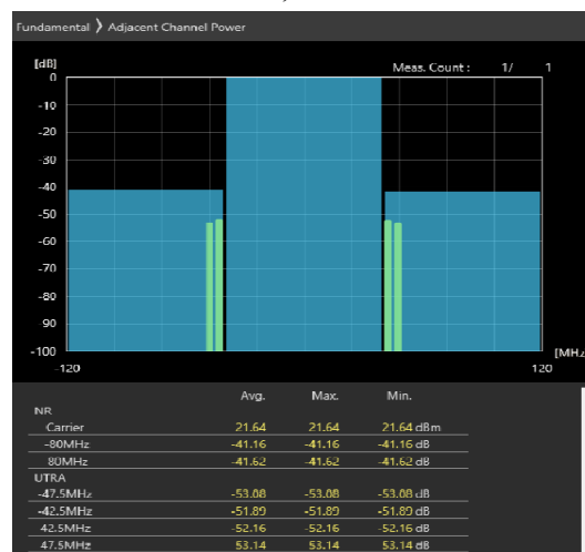
80MHz_30kHz_3660MHz-OFDM QPSK_RB216@0 -41.16,-41.62dB
