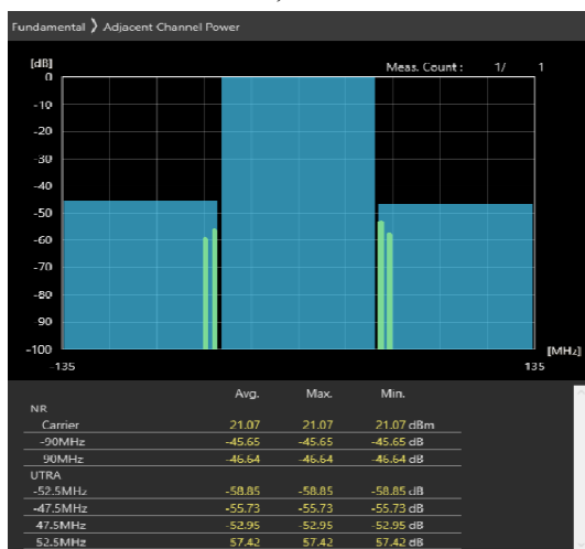
90MHz_30kHz_3655MHz-OFDM QPSK_RB1@244 -45.65,-46.64dB
