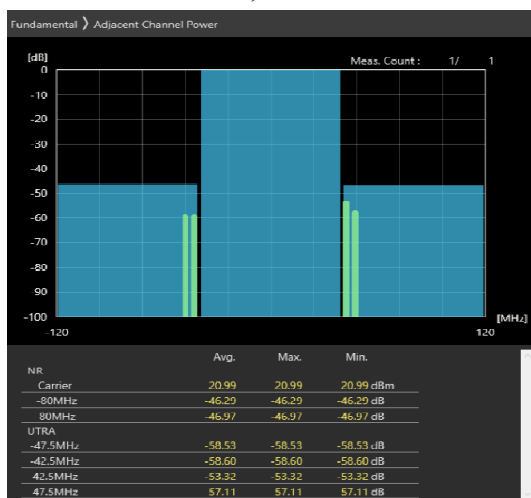
80MHz_30kHz_3660MHz-OFDM QPSK_RB1@216 -46.29,-46.97dB
