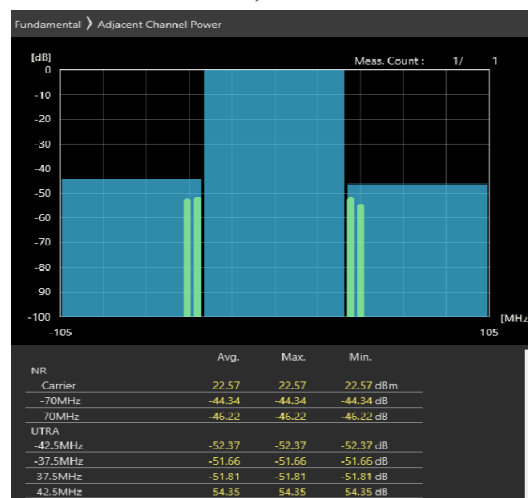
70MHz_30kHz_3665MHz-OFDM QPSK_RB90@45 -44.34,-46.22dB
