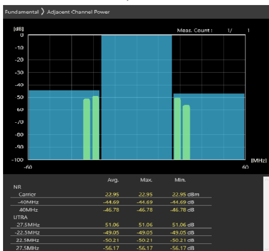
40MHz_30kHz_3680MHz-OFDM QPSK_RB1@105 -49.05,-48.28dB
