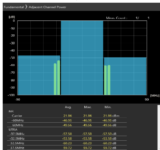
60MHz_30kHz_3670MHz-OFDM QPSK_RB162@0 -42.34,-42.37dB
