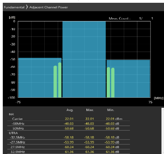
50MHz_30kHz_3675MHz-OFDM QPSK_RB128@0 -41.48,-41.4dB
