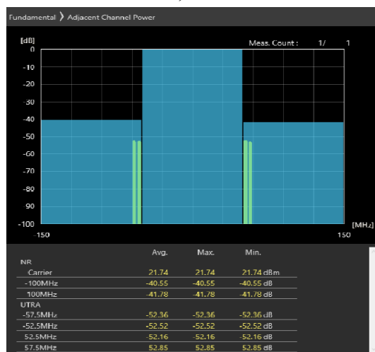
100MHz_30kHz_3650MHz-OFDM QPSK_RB270@0 -40.55,-41.78dB
