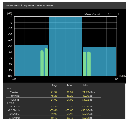
40MHz_30kHz_3680MHz-OFDM QPSK_RB100@0 -42.6,-42.97dB
