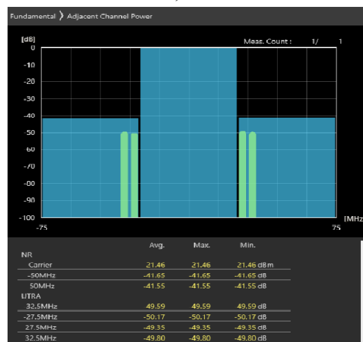
50MHz_30kHz_3675MHz-OFDM QPSK_RB64@32 -45.03,-46.58dB
