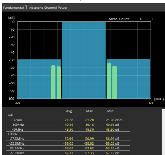
40MHz_30kHz_3680MHz-OFDM QPSK_RB1@105 -49.16,-48.3dB
