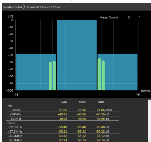
50MHz_30kHz_3675MHz-OFDM QPSK_RB1@132 -48.36,-48.08dB
