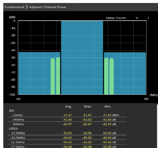
40MHz_30kHz_3680MHz-OFDM QPSK_RB50@25 -44.99,-46.96dB
