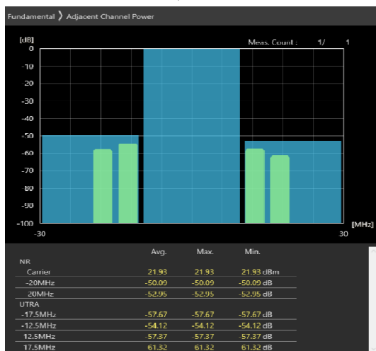
20MHz_30kHz_3560MHz-OFDM QPSK_RB50@0 -43.24,-43.58dB
