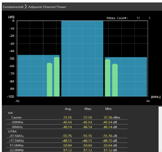
30MHz_30kHz_3685MHz-OFDM QPSK_RB36@18 -45.54,-48.14dB
