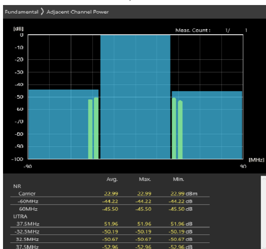
60MHz_30kHz_3670MHz-OFDM QPSK_RB1@161 -47.19,-47.29dB
