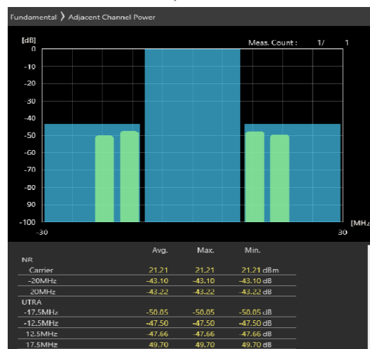
20MHz_30kHz_3690MHz-OFDM QPSK_RB50@0 -43.1,-43.22dB
