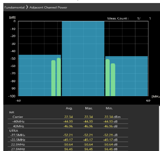
40MHz_30kHz_3680MHz-OFDM QPSK_RB50@25 -44.99,-46.96dB
