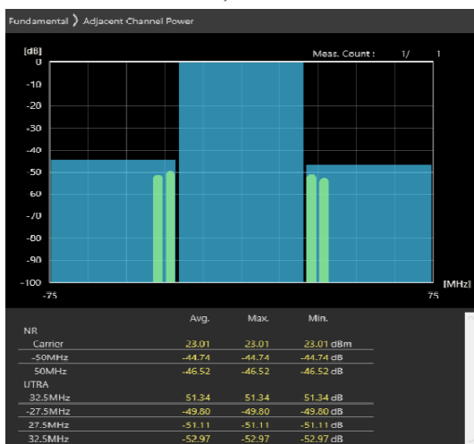
50MHz_30kHz_3675MHz-OFDM QPSK_RB1@132 -48.36,-48.08dB
