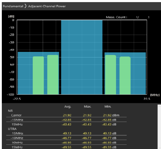
15MHz_30kHz_3692.5MHz-OFDM QPSK_RB1@37 -52,-49.7dB
