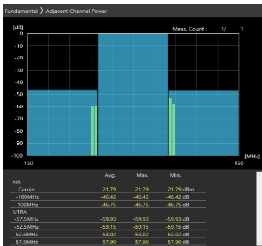
100MHz_30kHz_3650MHz-OFDM QPSK_RB1@272 -46.42,-46.75dB
