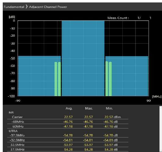
60MHz_30kHz_3670MHz-OFDM QPSK_RB81@40 -46.76,-47.18dB
