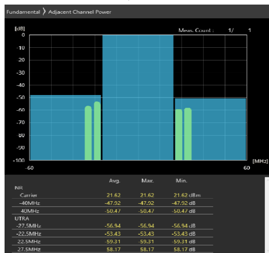
40MHz_30kHz_3680MHz-OFDM QPSK_RB100@0 -44.83,-44.71dB
