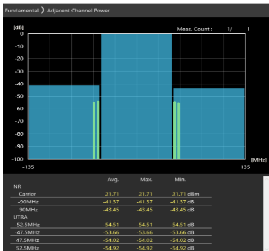
90MHz_30kHz_3655MHz-OFDM QPSK_RB1@244 -46.41,-47dB
