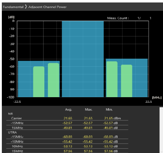
15MHz_30kHz_3692.5MHz-OFDM QPSK_RB1@37 -52.57,-49.81dB
