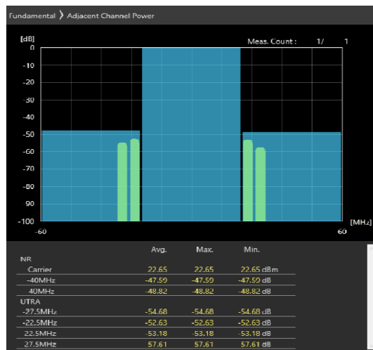
40MHz_30kHz_3680MHz-OFDM QPSK_RB50@25 -47.59,-48.82dB
