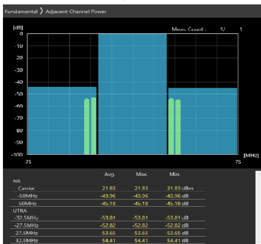
50MHz_30kHz_3575MHz-OFDM QPSK_RB64@32 -47.21,-48.95dB
