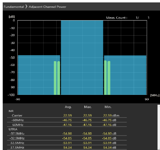
60MHz_30kHz_3670MHz-OFDM QPSK_RB81@40 -46.75,-47.16dB
