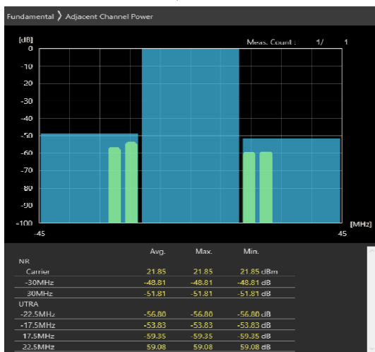
30MHz_30kHz_3565MHz-OFDM QPSK_RB75@0 -44.99,-46.77dB
