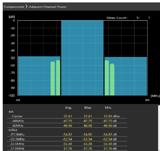
40MHz_30kHz_3680MHz-OFDM QPSK_RB50@25 -47.79,-48.98dB
