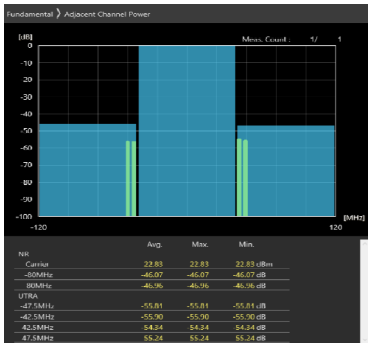
80MHz_30kHz_3590MHz-OFDM QPSK_RB216@0 -41.96,-43.34dB
