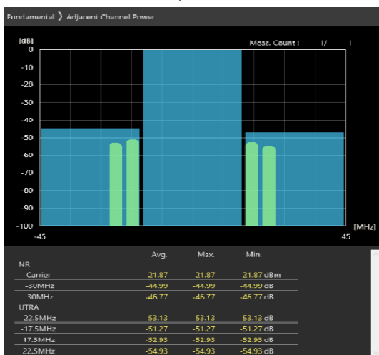
30MHz_30kHz_3685MHz-OFDM QPSK_RB36@18 -48.13,-49.86dB
