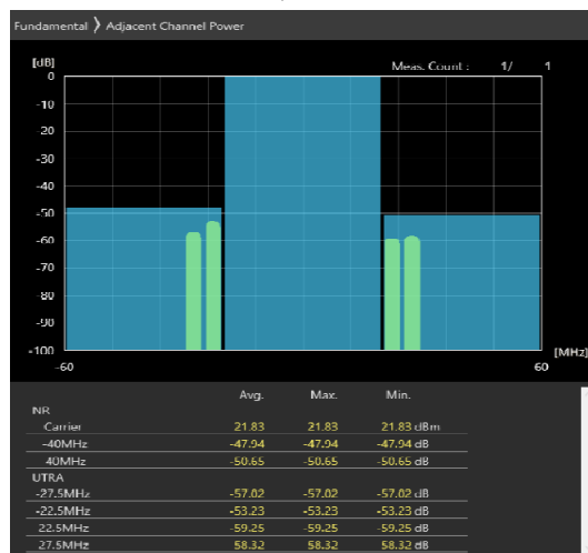
40MHz_30kHz_3680MHz-OFDM QPSK_RB100@0 -44.95,-44.65dB
