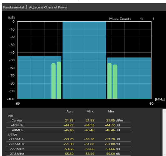
40MHz_30kHz_3570MHz-OFDM QPSK_RB50@25 -47.75,-49.45dB
