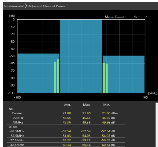
70MHz_30kHz_3665MHz-OFDM QPSK_RB180@0 -42.75,-42.02dB
