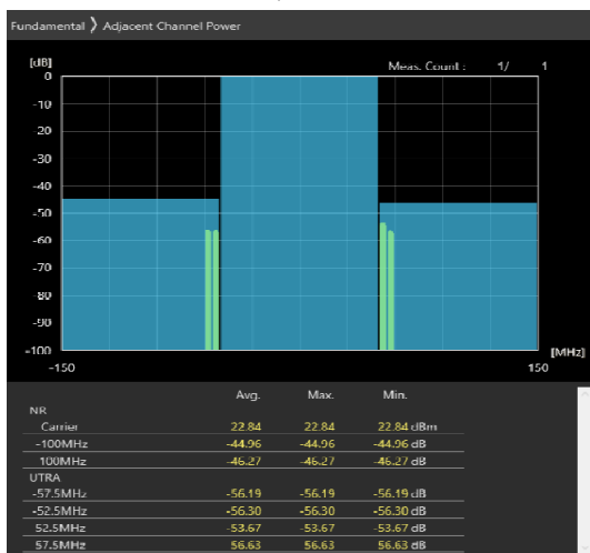
100MHz_30kHz_3600MHz-OFDM QPSK_RB270@0 -40.85,-43.47dB
