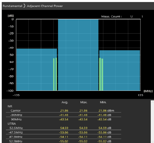
90MHz_30kHz_3655MHz-OFDM QPSK_RB1@244 -46.37,-47dB
