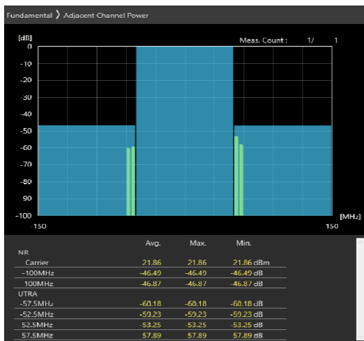
100MHz_30kHz_3650MHz-OFDM QPSK_RB1@272 -46.49,-46.87dB
