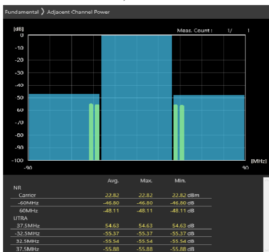
60MHz_30kHz_3670MHz-OFDM QPSK_RB1@161 -47.98,-47.53dB
