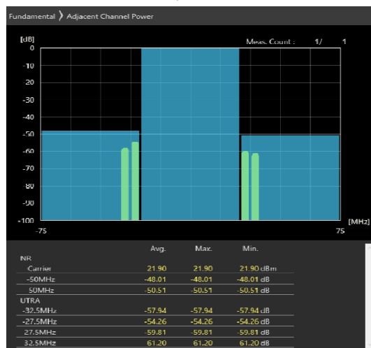
50MHz_30kHz_3675MHz-OFDM QPSK_RB128@0 -44.36,-43.09dB
