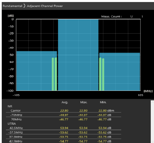
70MHz_30kHz_3665MHz-OFDM QPSK_RB1@188 -47.72,-47.39dB
