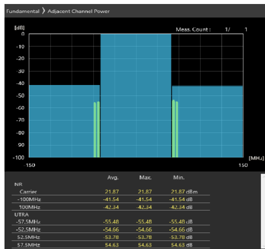
100MHz_30kHz_3650MHz-OFDM QPSK_RB270@0 -41.54,-42.34dB
