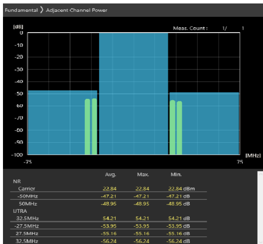
50MHz_30kHz_3675MHz-OFDM QPSK_RB1@132 -49.19,-48.47dB
