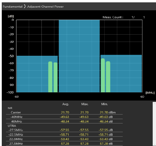
40MHz_30kHz_3680MHz-OFDM QPSK_RB1@105 -49.63,-48.34dB
