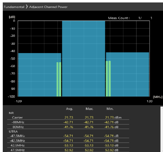
80MHz_30kHz_3660MHz-OFDM QPSK_RB216@0 -42.71,-41.76dB
