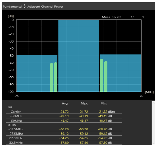
50MHz_30kHz_3675MHz-OFDM QPSK_RB1@132 -49.19,-48.47dB
