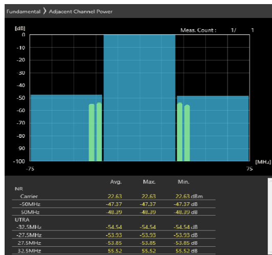
50MHz_30kHz_3675MHz-OFDM QPSK_RB64@32 -47.37,-48.39dB
