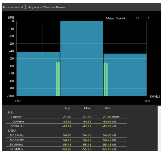
100MHz_30kHz_3650MHz-OFDM QPSK_RB1@272 -46.49,-46.87dB
