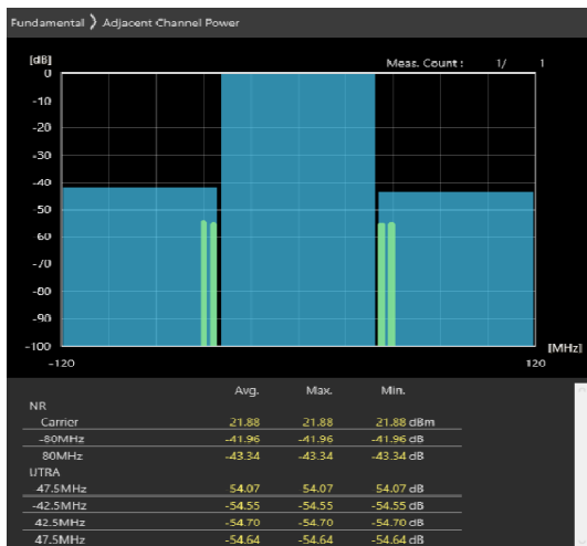
80MHz_30kHz_3660MHz-OFDM QPSK_RB1@216 -47.19,-47.34dB
