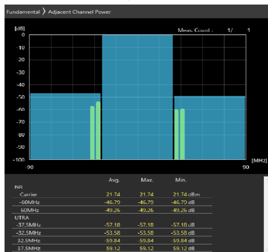
60MHz_30kHz_3670MHz-OFDM QPSK_RB162@0 -44.02,-42.84dB
