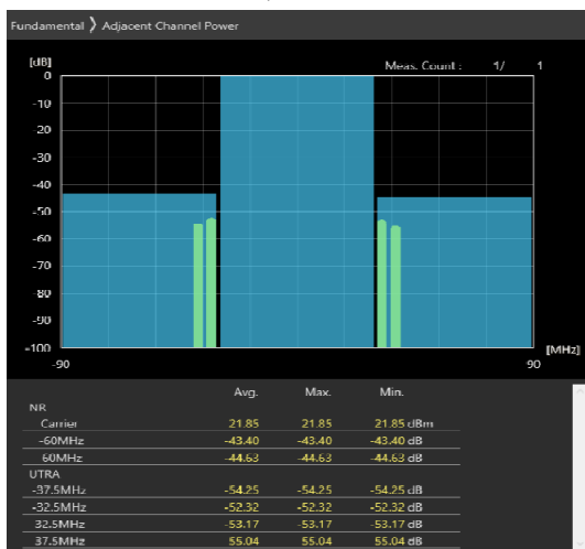
60MHz_30kHz_3580MHz-OFDM QPSK_RB81@40 -46.8,-48.11dB
