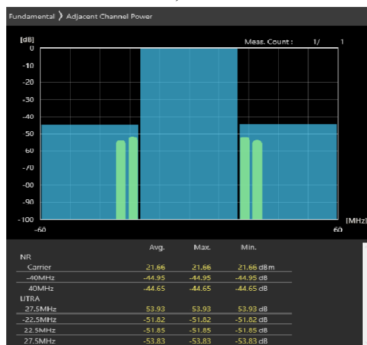
40MHz_30kHz_3680MHz-OFDM QPSK_RB50@25 -47.79,-48.98dB
