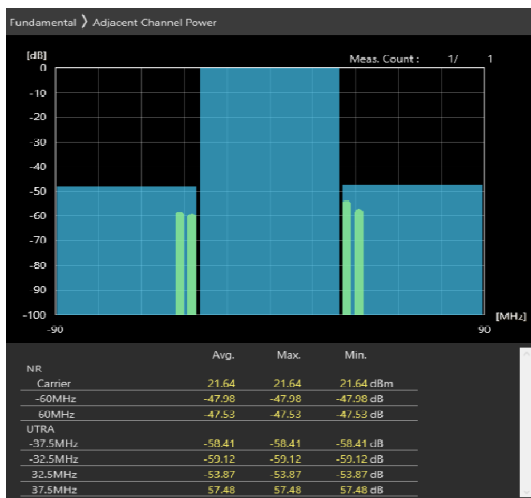
60MHz_30kHz_3670MHz-OFDM QPSK_RB1@161 -47.98,-47.53dB
