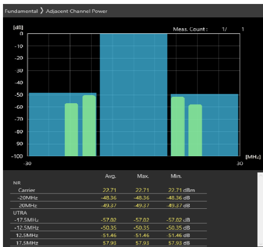
20MHz_30kHz_3690MHz-OFDM QPSK_RB25@12 -48.36,-49.37dB
