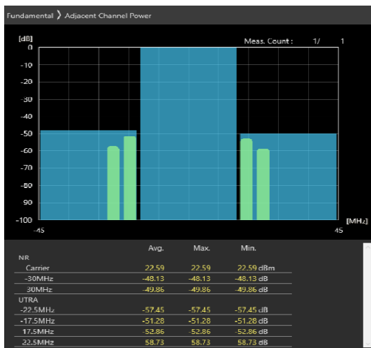
30MHz_30kHz_3685MHz-OFDM QPSK_RB36@18 -48.13,-49.86dB
