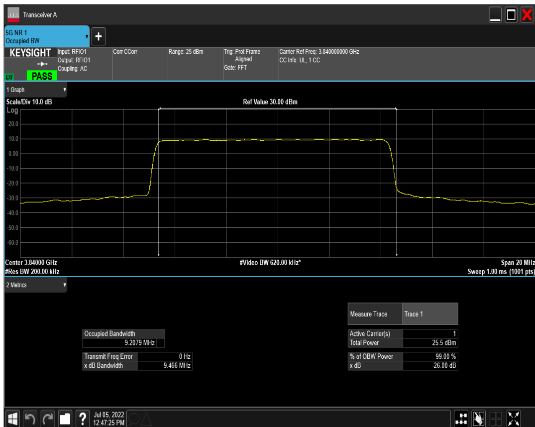
n77(3700-3980) SCS=15kHz DFT_QAM16 BW=10MHz Channel=656000 RB=50@0
