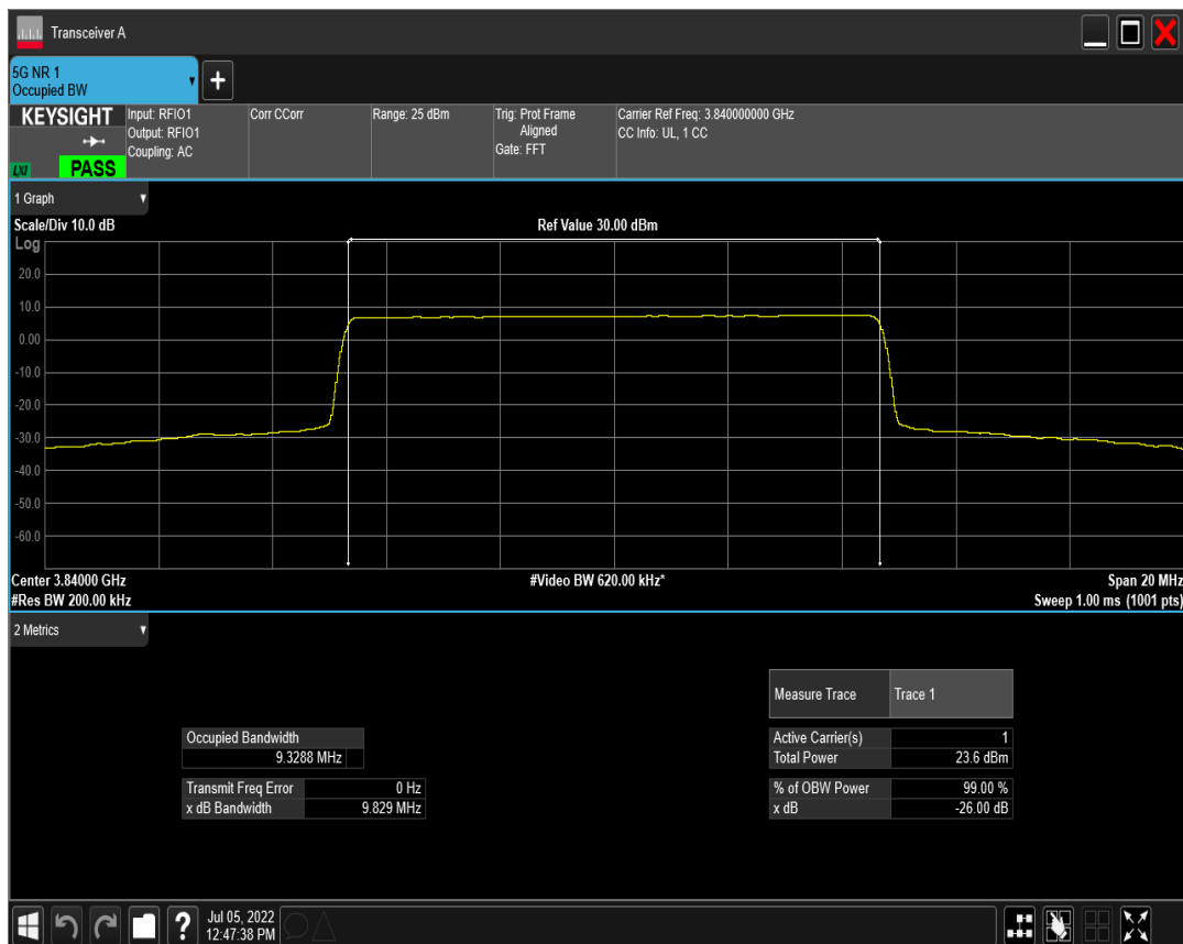
n77(3700-3980) SCS=15kHz DFT_BPSK BW=10MHz Channel=665000 RB=50@0
