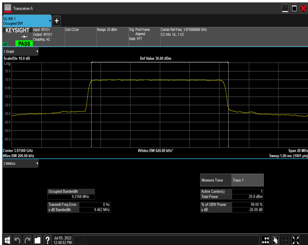
n77(3700-3980) SCS=15kHz DFT_QAM16 BW=10MHz Channel=665000 RB=50@0
