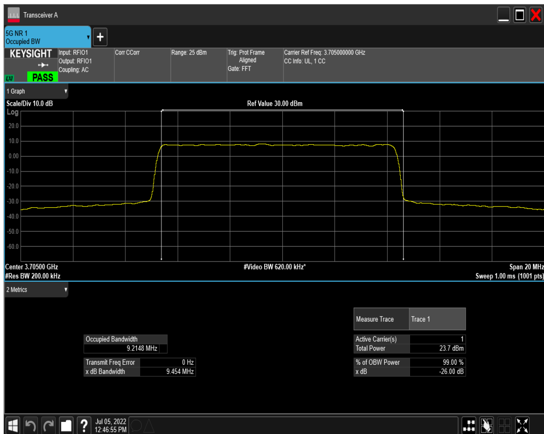
n77(3700-3980) SCS=15kHz DFT_QAM256 BW=10MHz Channel=647000 RB=50@0
