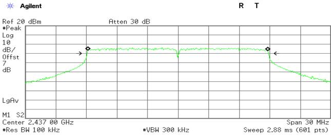
Occupied Bandwidth 17.6611 MHz Осс ВW % Рыг 99.00 % х dB -6.00 dB
