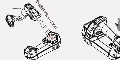
注释: 激光中心需对准条码中心。
