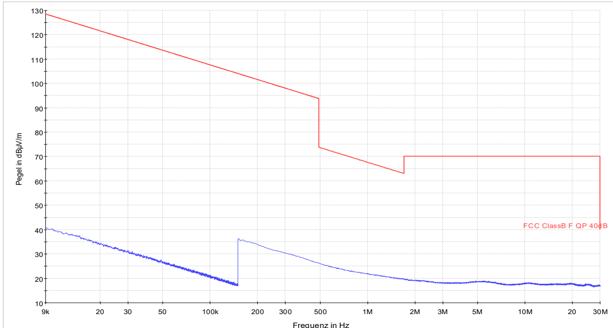
— QPK_MAXH(1):VPeg_1.3_BWRY_CH10_F0 [VPeg_1.3_BWRY_CH10_F0.Result2] — QPK_CLRWR [Ergebnistabelle.Result1] — FCC ClassB F QP 40dB [..EMI radiated] — QPK_MAXH [Ergebnistabelle.Result2]
