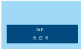
没外接信号电源的情况下开机出现如上图所以（无信号，调不出任何菜单）
