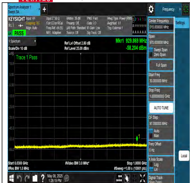
NTNV-N77-3450-3550-PC3-30-15-L-DFT-QPSK- Edge 1RB Left-Ant1-PASS
