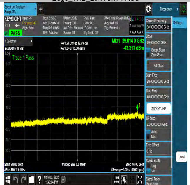
NTNV-N77-3450-3550-PC3-30-15-L-DFT-QPSK- Edge 1RB Left-Ant1-PASS
