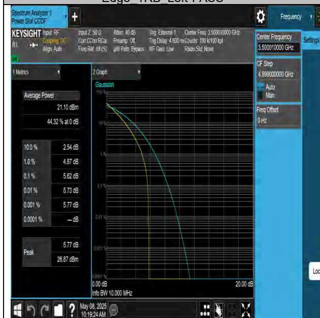
NTNV-N77-3450-3550-PC3-30-10-M-DFT-QPSK-Edge 1RB Left-PASS
