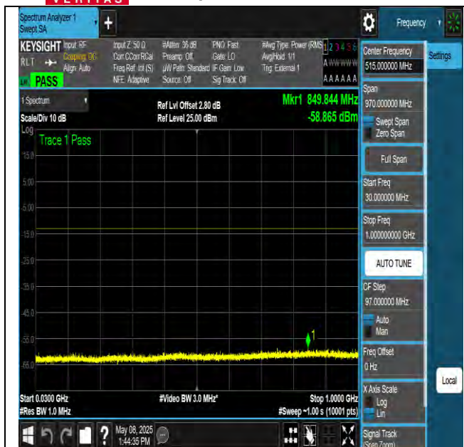
NTNV-N77-3450-3550-PC3-30-20-L-DFT-QPSK- Edge 1RB Left-Ant1-PASS
