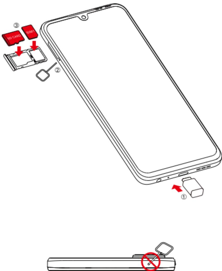
**¡ATENCIÓN!** No ingrese el pin de la SIM en el altavoz en la parte superior del teléfono.
