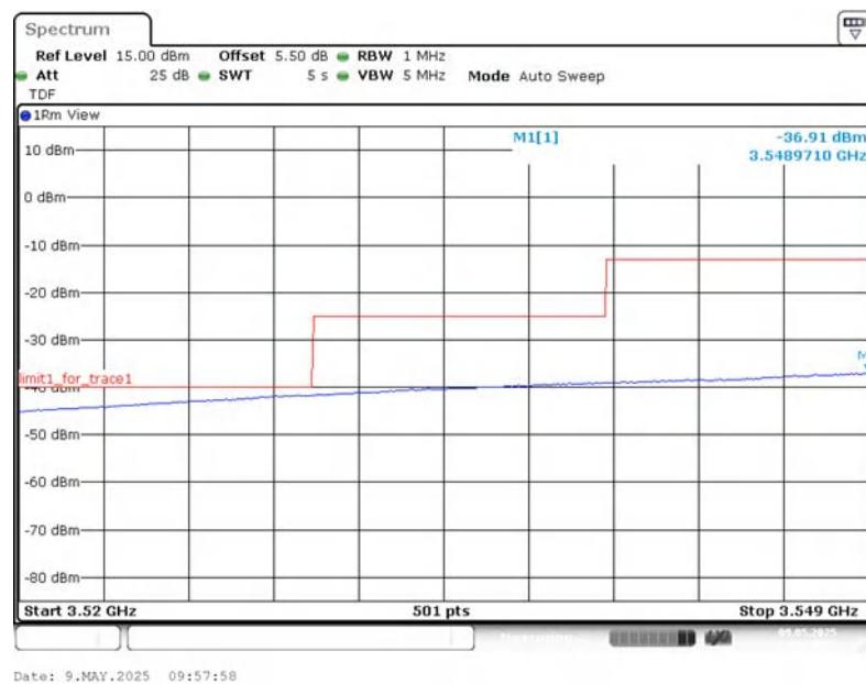
**LOW BAND EDGE BLOCK-20MHz+20MHz-100%RB**
