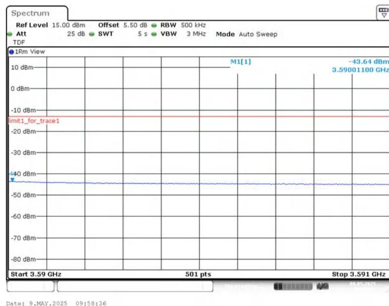
**LOW BAND EDGE BLOCK-20MHz+20MHz-100%RB**
