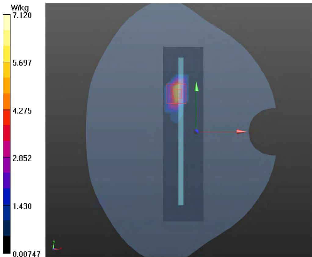
**Plot 87 LTE Band 66 50%RB Bottom Edge High (Distance 0mm)**
