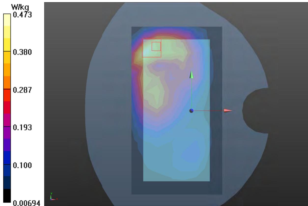
**Plot 72 LTE Band 4 1RB Back Side Low (Distance 10mm)**
