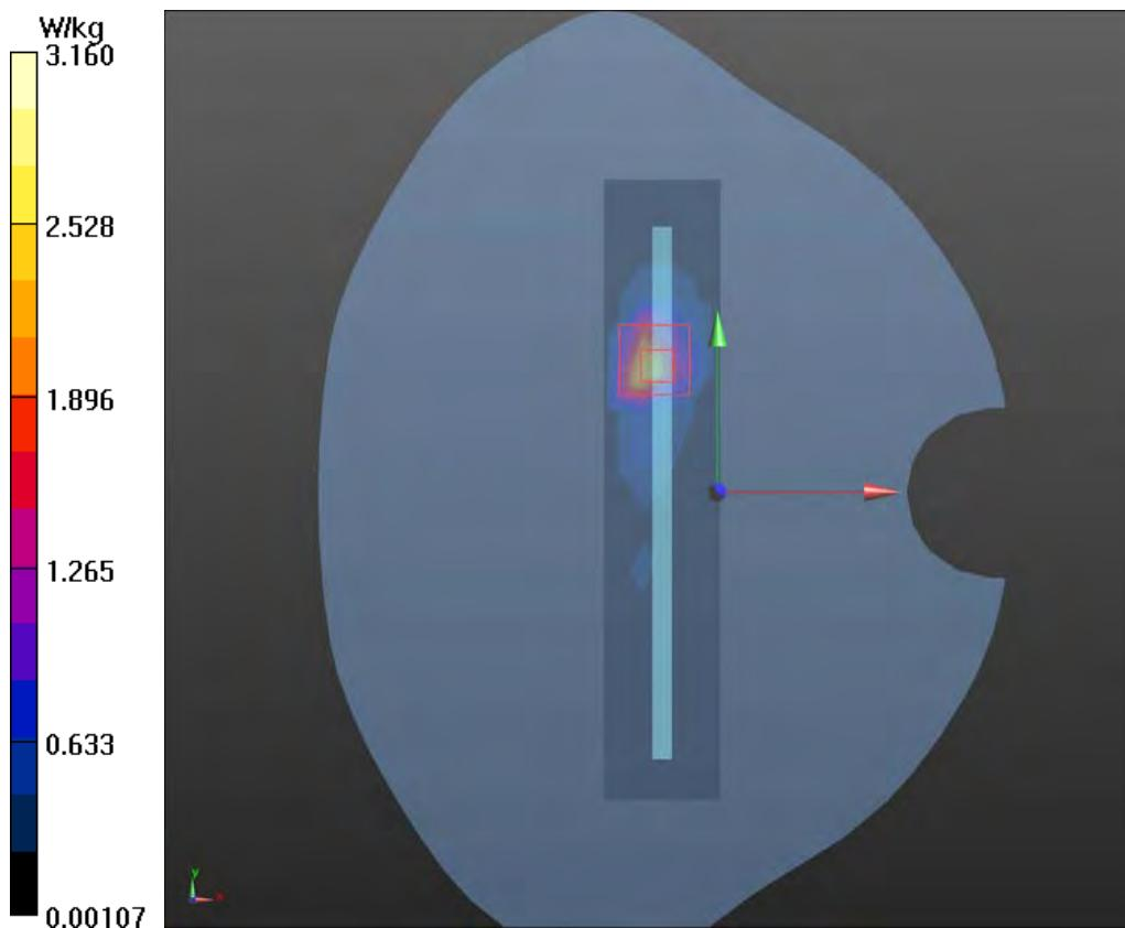
**Plot 116 LTE Band 66 50%RB Bottom Edge High (Distance 0mm)**
