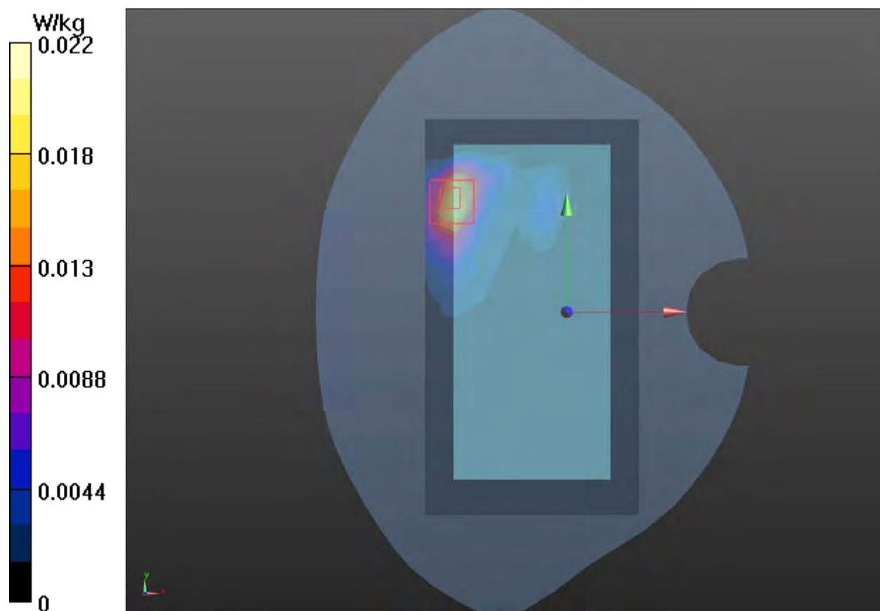
**Plot 113 LTE Band 2 50%RB Bottom Edge Low (Distance 0mm)**
