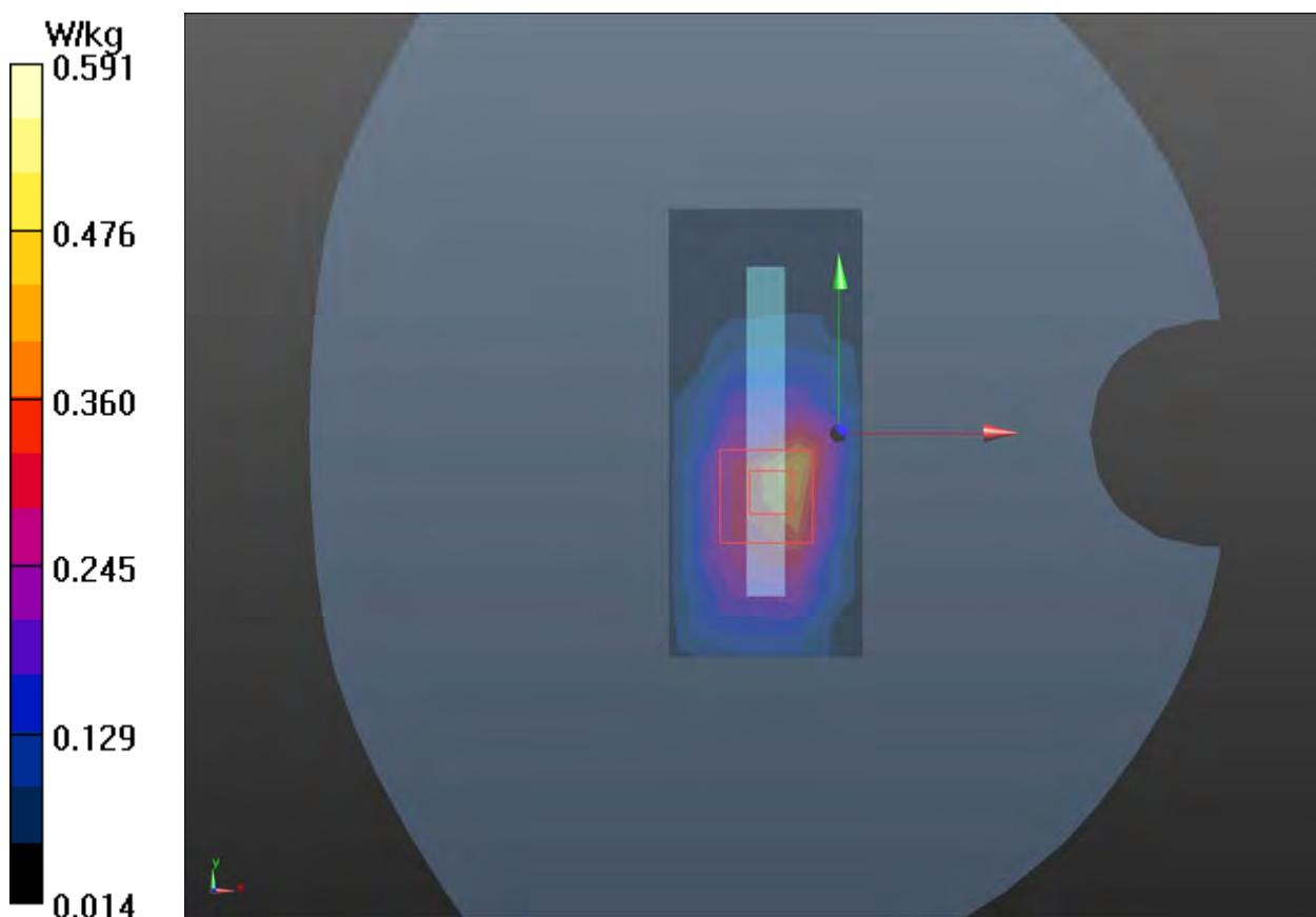
**Plot 96 LTE Band 25 50%RB Back Side High (Distance 10mm)**
