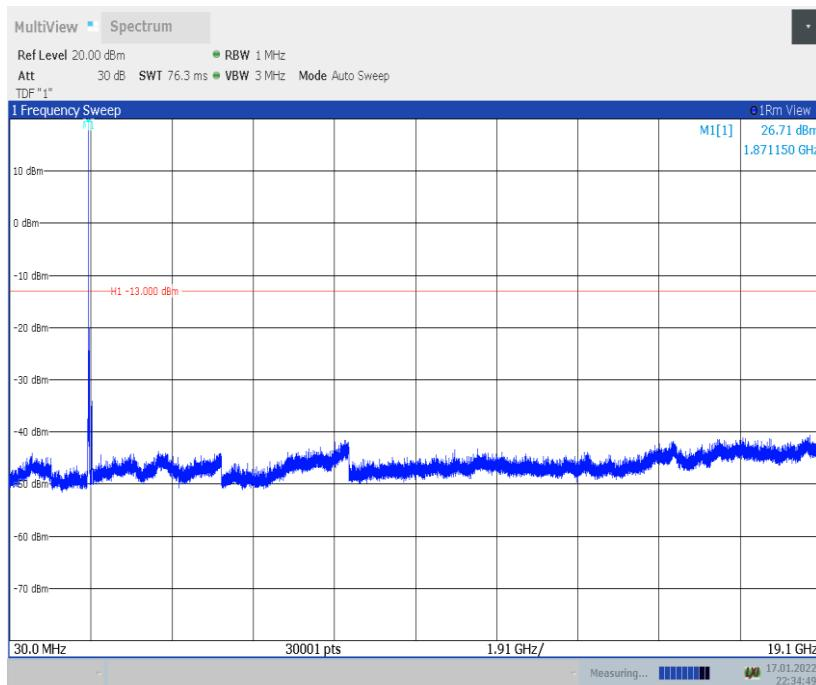
**LTE band 7 20MHz QPSK: 30MHz – 25.7GHz**
