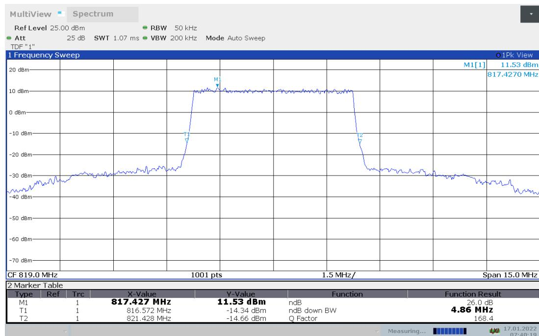
**LTE band 26(814MHz-824MHz),10MHz(-26dBc)**
