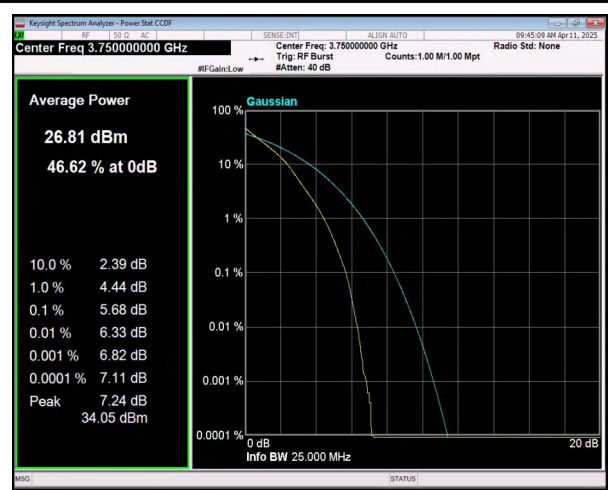
n78(3700-3800) SCS=30kHz DFT_QPSK BW=20MHz Channel=650000 RB=50@0
