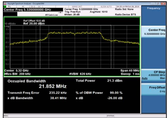
U-NII-2a 26dB Bandwidth-802.11ac(20MHz),5300MHz,Ant1
