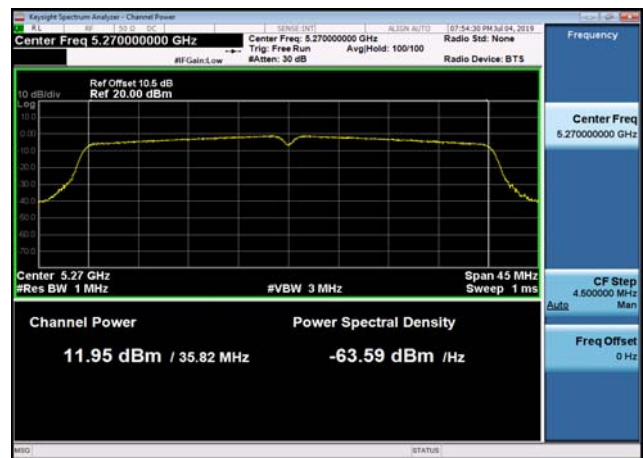
U-NII-2a Output Power-802.11n(40MHz) ,5270MHz
