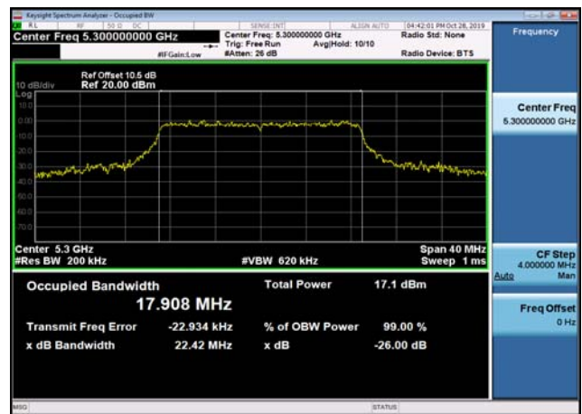
U-NII-2a 26dB Bandwidth-802.11ac(20MHz),5300MHz,Ant1
