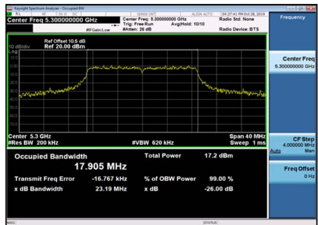
U-NII-2a 26dB Bandwidth-802.11n(40MHz) ,5270MHz,Ant1
