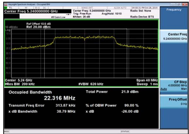
U-NII-1 26dB Bandwidth-802.11ac(20MHz) ,5220MHz,Ant1
