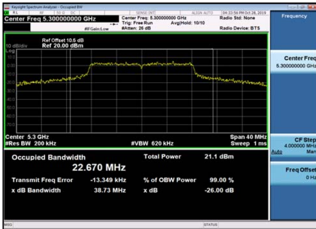
U-NII-2a 26dB Bandwidth-802.11ac(20MHz),5260MHz,Ant1
