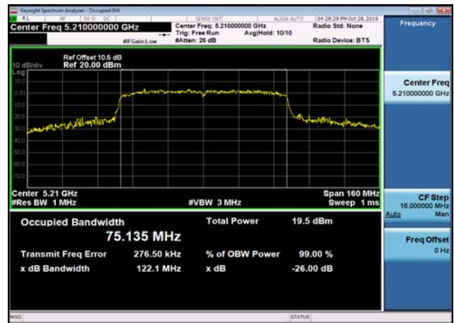
U-NII-1 26dB Bandwidth-802.11ac(80MHz) ,5210MHz,Ant1
