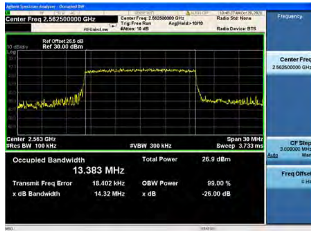
Band41 / 15MHz / Mid CH / QPSK
