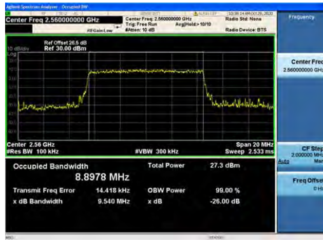
Band41 / 10MHz / Mid CH / QPSK
