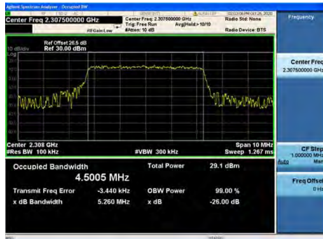
Band40/ Block A / 5MHz / Mid CH / QPSK
