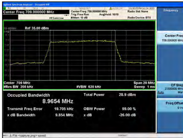
Band17 / 10MHz / Mid CH / QPSK
