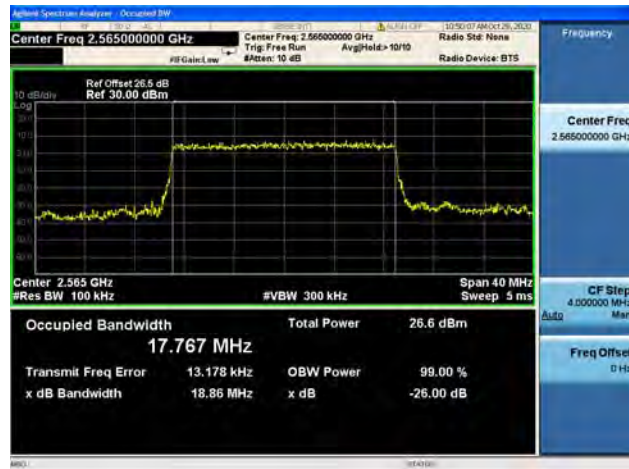
Band41 / 20MHz / Mid CH / QPSK
