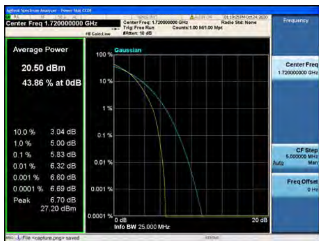
Band4 / 20MHz / Mid CH / 16QAM
