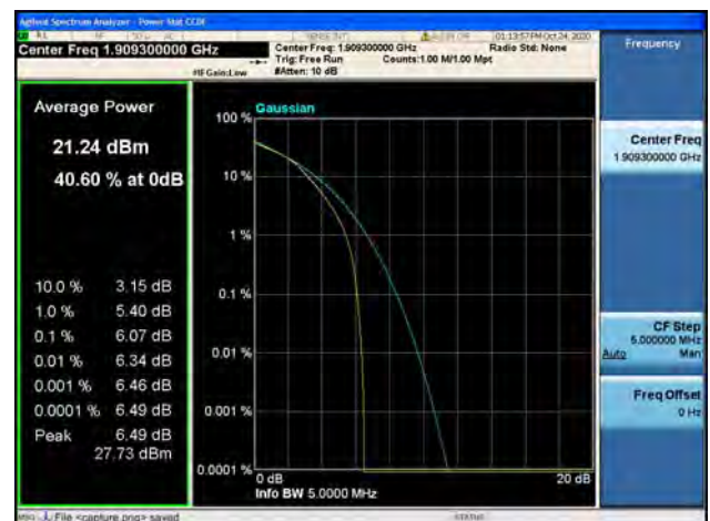
Band2 / 1.4MHz / High CH / 16QAM
