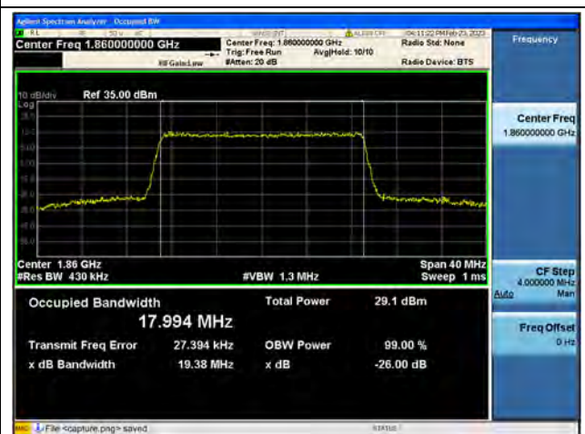
Band2 / 20MHz / 64QAM/ Low CH
