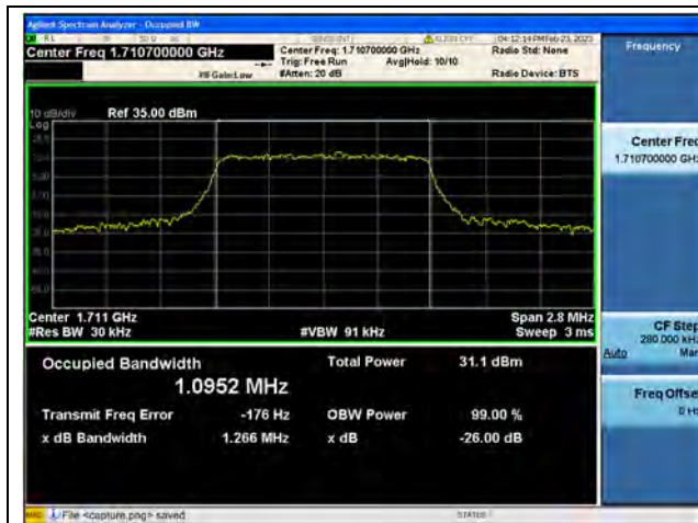
Band4 / 1.4MHz / QPSK/ Low CH
