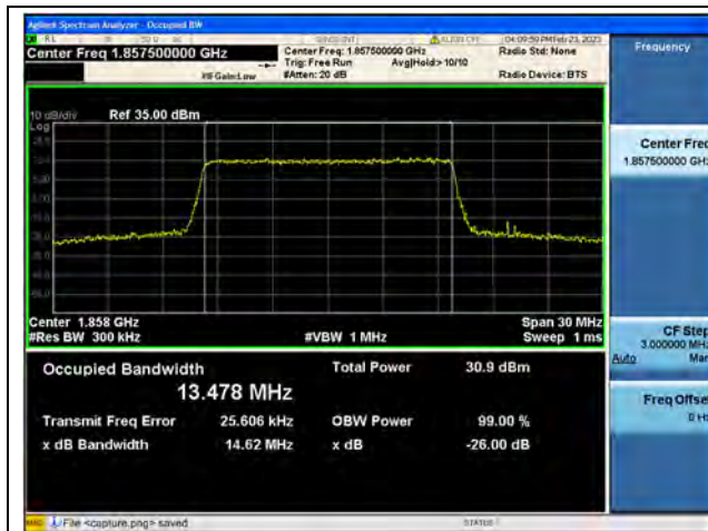
Band2 / 15MHz / QPSK/ Low CH
