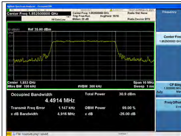
Band2 / 5MHz / QPSK/ Low CH
