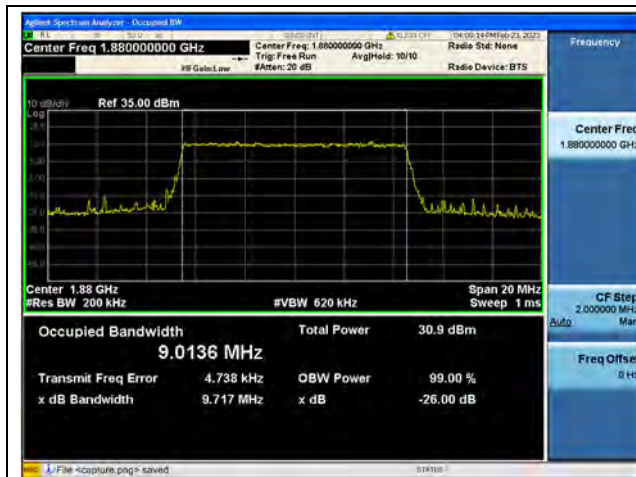
Band2 / 10MHz / QPSK/ Mid CH
