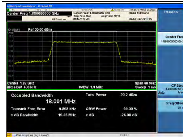
Band2 / 20MHz / 64QAM/ Mid CH
