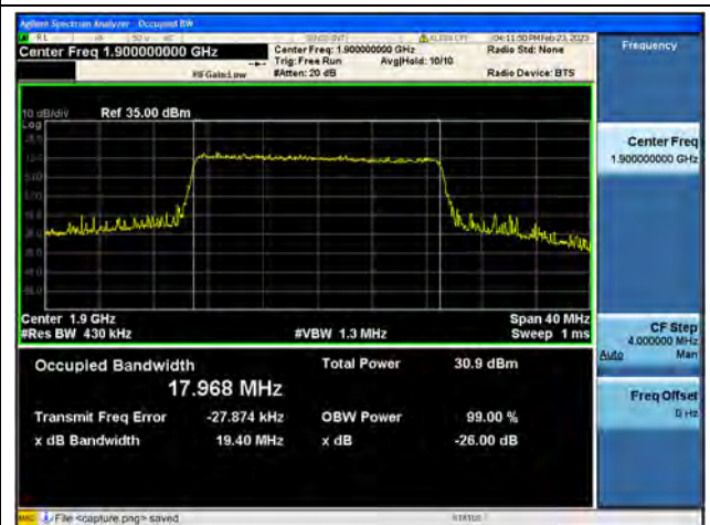
Band2 / 20MHz / QPSK/ High CH
