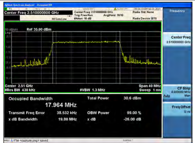
Band7 / 20MHz / QPSK/ Low CH
