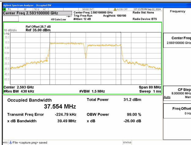
41C / 20+20MHz / QPSK/ Mid CH
