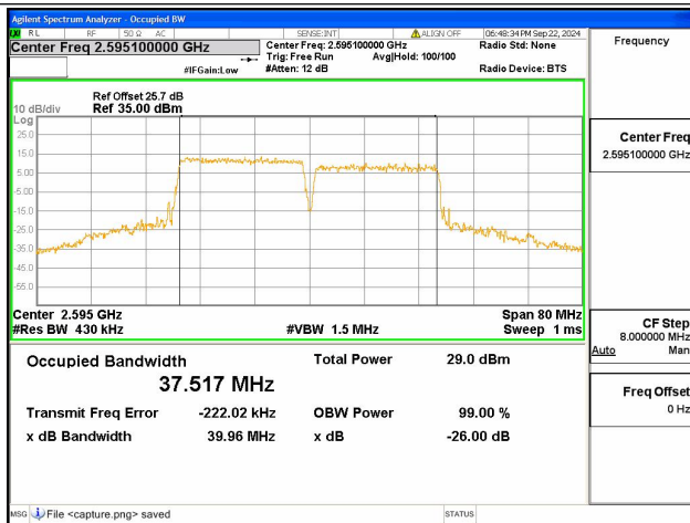
38C / 20+20MHz / QPSK/ Mid CH
