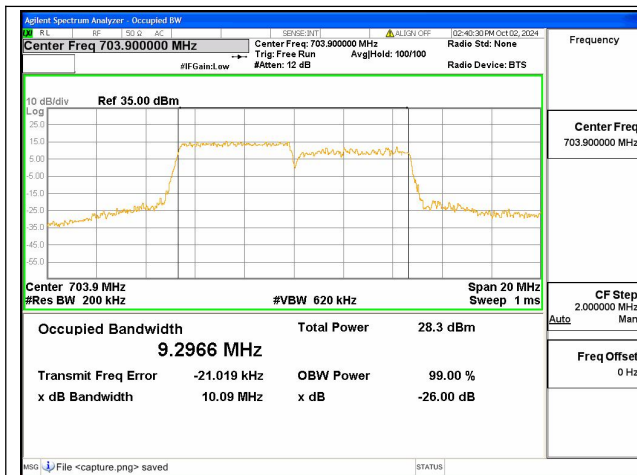
12B / 5+5MHz / QPSK / Low CH
