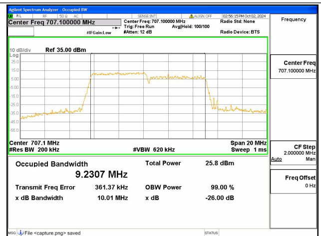
12B / 5+5MHz / 256QAM/ Mid CH
