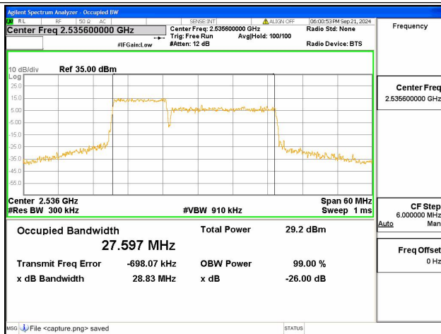
7C / 10+20MHz / QPSK/ Mid CH
