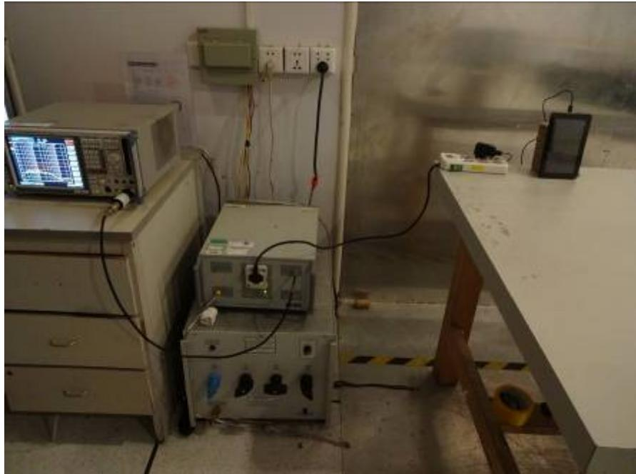
**RADIATED EMISSION TEST BLOW 1GHz**
