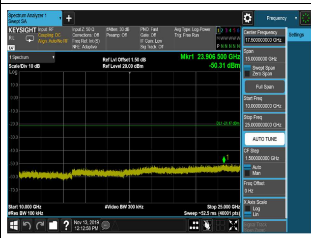
DQPSK,2480MHz,2DH5,Plot 4,10000MHz~25 000MHz
