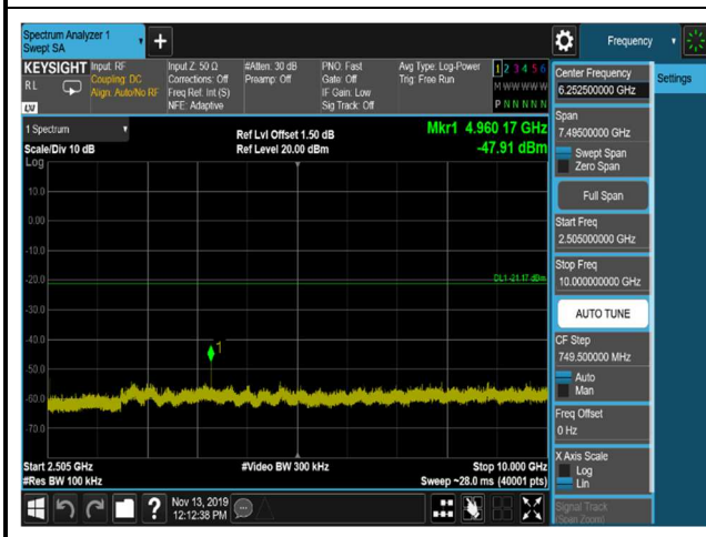
DQPSK,2480MHz,2DH5,Plot 3,2505MHz~100 00MHz
