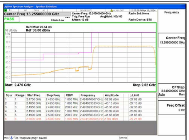
B7 / 20MHz / Low CH / QPSK / FULL RB
