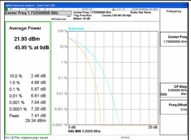
B4 / 5MHz / Mid CH / QPSK
