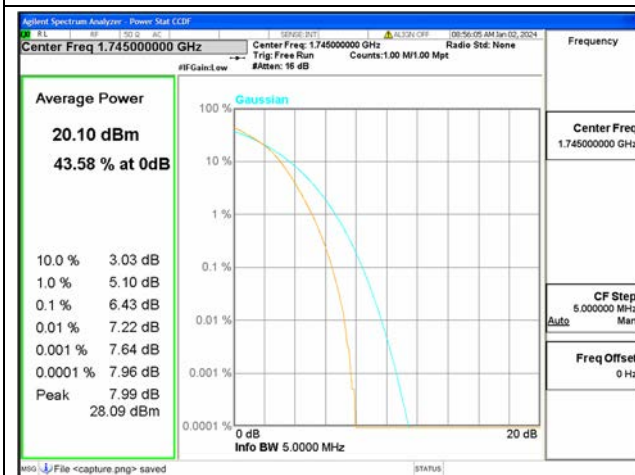
B66 / 5MHz / Mid CH / 16QAM
