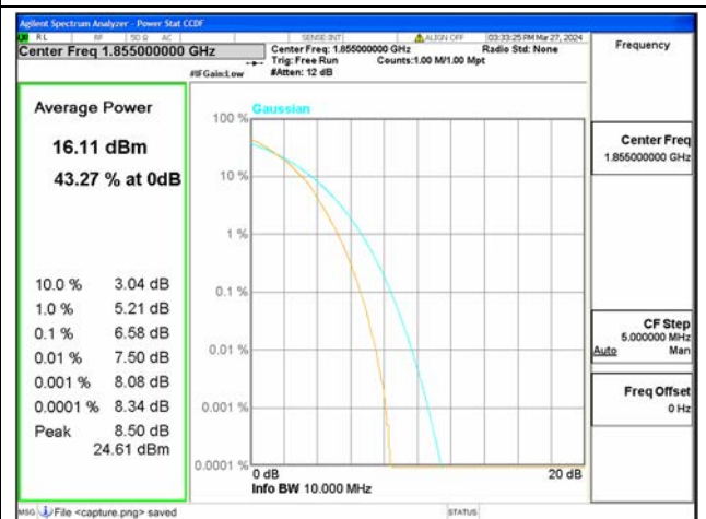
B25 / 10MHz / Low CH / 64QAM
