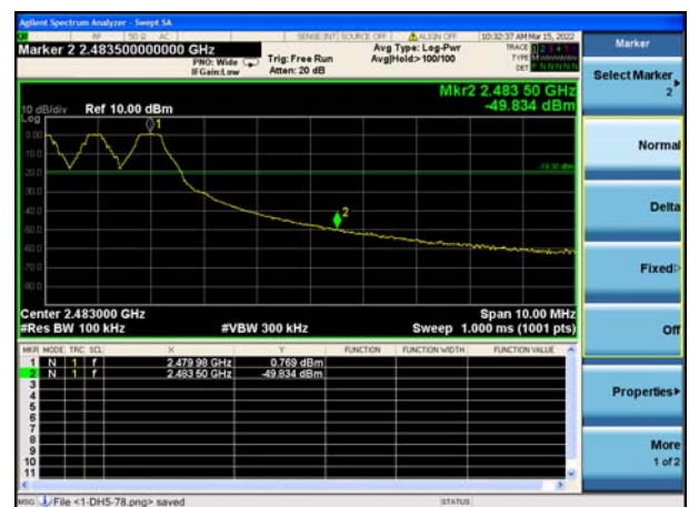
Right Band edge hopping on
