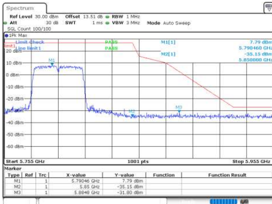
Band Edge NVNT ac40 5795MHz High Ant 1
