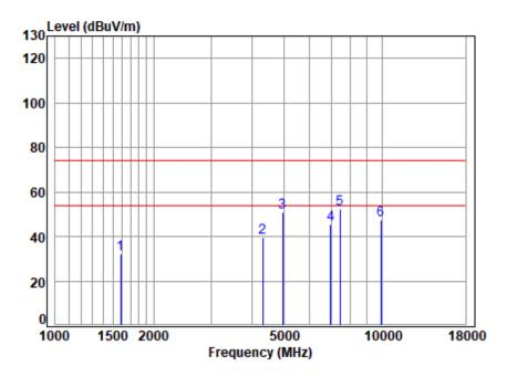
Site : chamber Condition: 3m VERTICAL : 02855HS/02856HS : 2480 TX RSE Mode : BLE-1M Note
