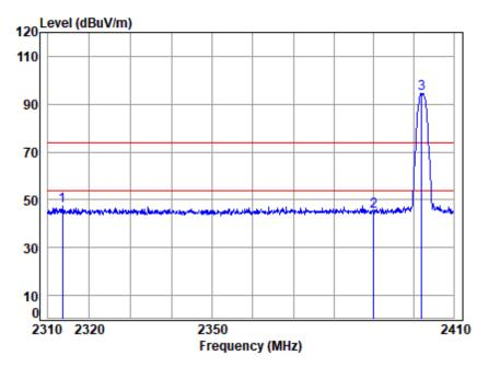
Site : chamber Condition: 3m VERTICAL : 02855HS/02856HS : 2402 Band edge Mode
