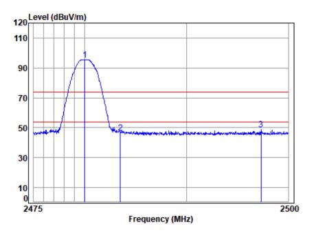
Site : chamber Condition: 3m VERTICAL : 02855HS/02856HS : 2480 Band edge Mode
