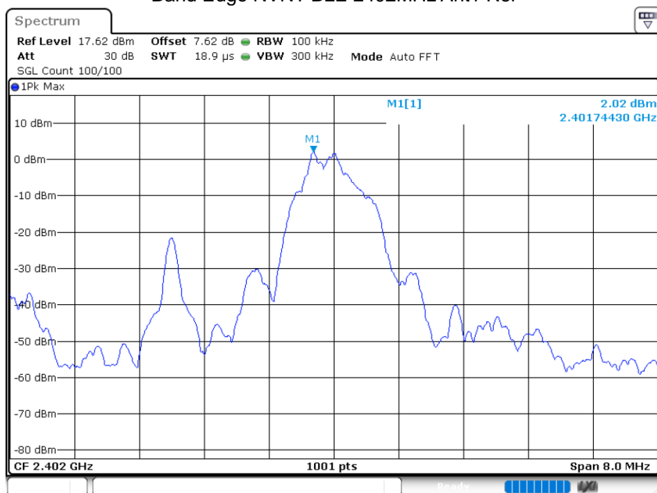
Band Edge NVNT BLE 2402MHz Ant1 Ref
