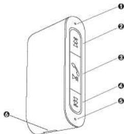
① 蓝牙状态指示灯 ② 上一曲/音量减小 ③ 接打电话/播放/暂停
