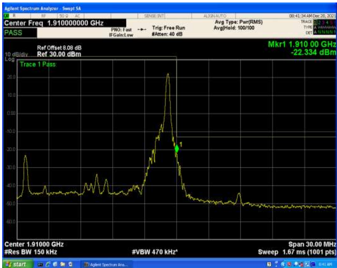
Band2 QPSK BW=20MHz Channel=18700 RB Size=1 Position=#0
