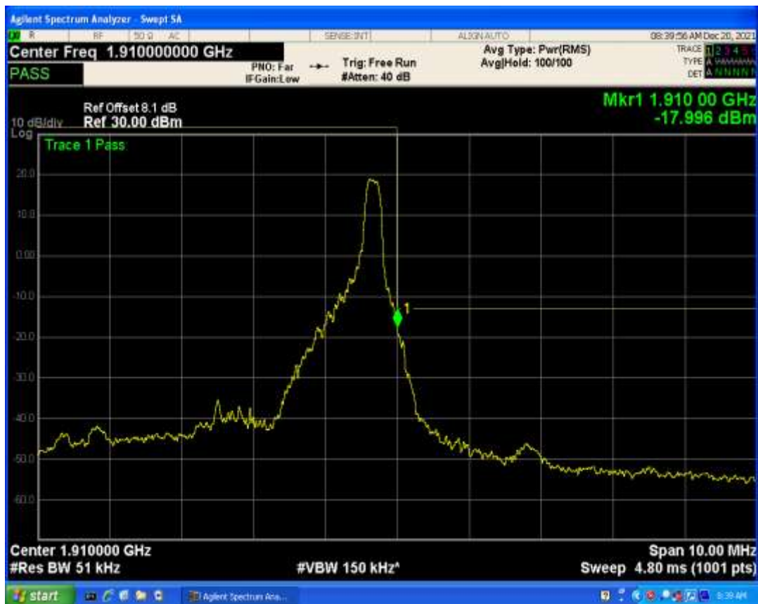
Band2 QPSK BW=10MHz Channel=18650 RB Size=1 Position=#0
