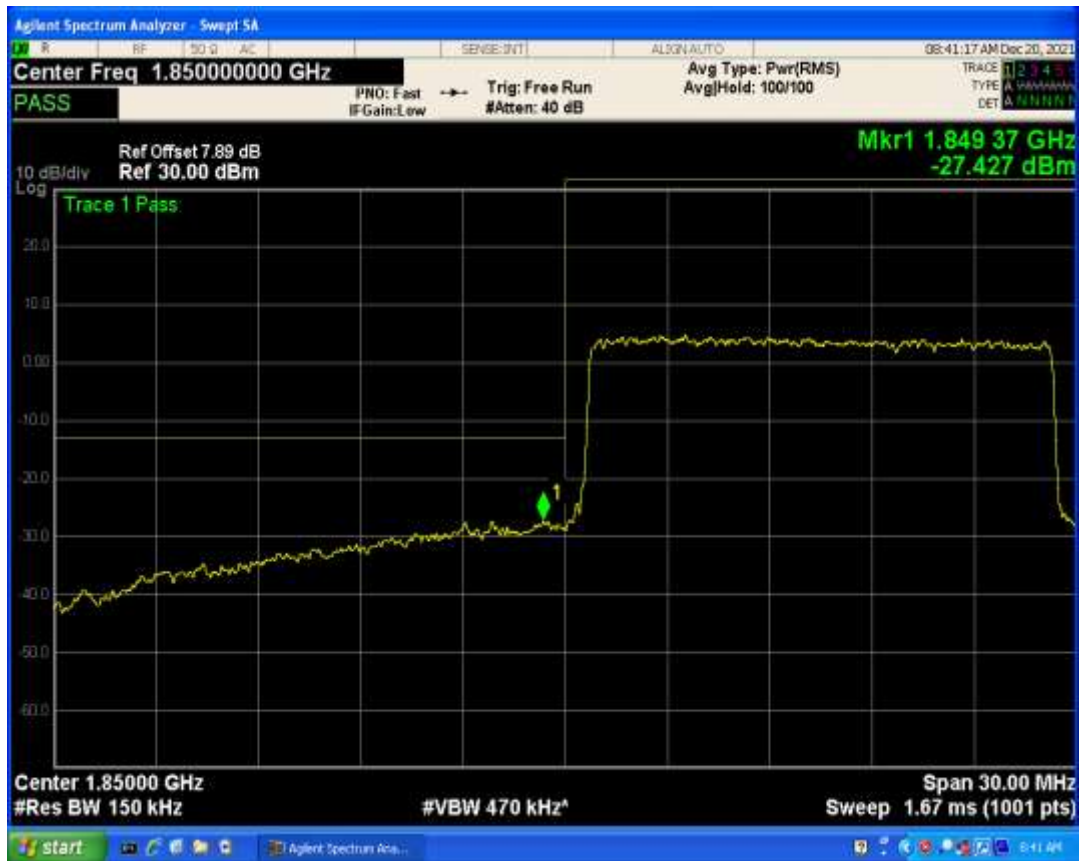
Band2 QPSK BW=15MHz Channel=19125 RB Size=1 Position=#0
