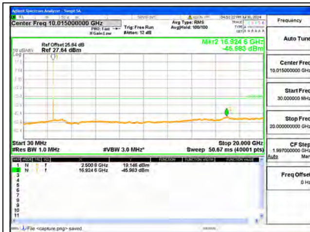
B7-30M-20G / 20MHz / Low CH / QPSK
