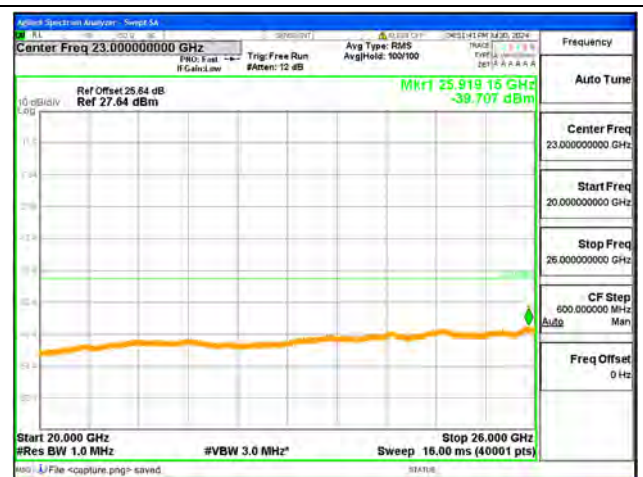
B7-20G-26G / 20MHz / Low CH / QPSK
